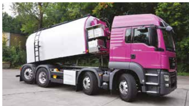
Kotel za liti asfalt
