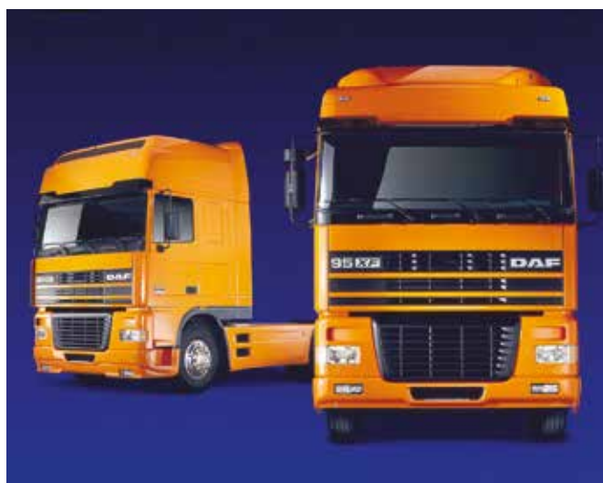
6 Tovornjak brez nosu ima boljši obračalni krog in večjo okretnost v ozkih mestih – zato so pogostejši v Evropi.
