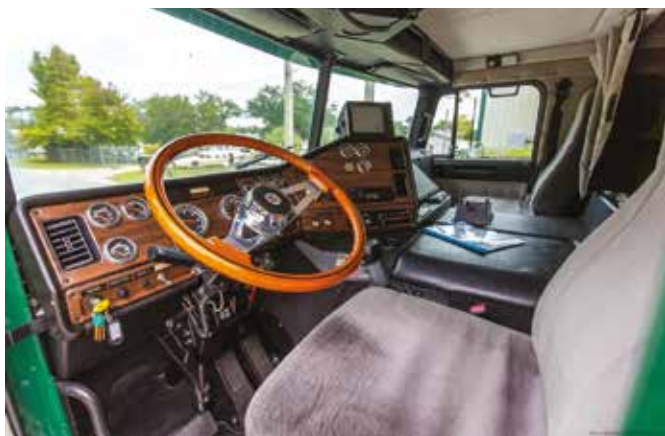
4 Kabina je običajno manjša, vožnja je bolj trda, saj voznik sedi tik nad kolesi in motorjem.
