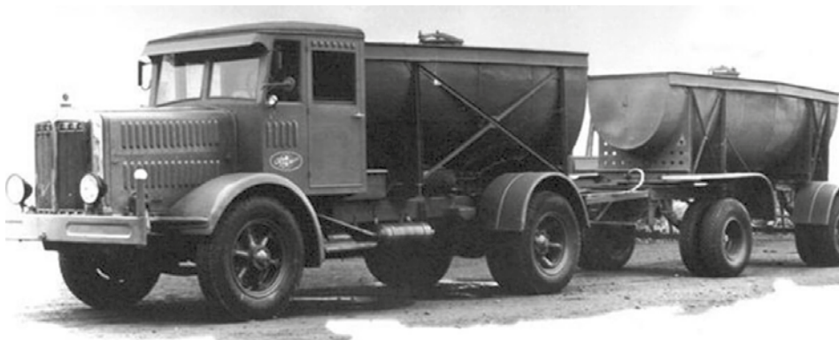
1 Model NAG 50 je bil dolg devet metrov, z le 80 konjskimi močmi pod pokrovom motorja je bila največja hitrost le 33 km/h.
