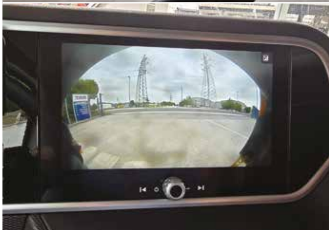
3 Sistem kamer, ki zamenjuje klasična vzratna ogleda (Direct Vision System), omogoča dobro vzratno preglednost tudi v pogojih zmanjšane vidljivosti. Dodatne črte so v veliko pomoč pri določanju globine. Še ena kamera pa je nameščena za kabino in pomaga pri priklapljanju prikolice.
