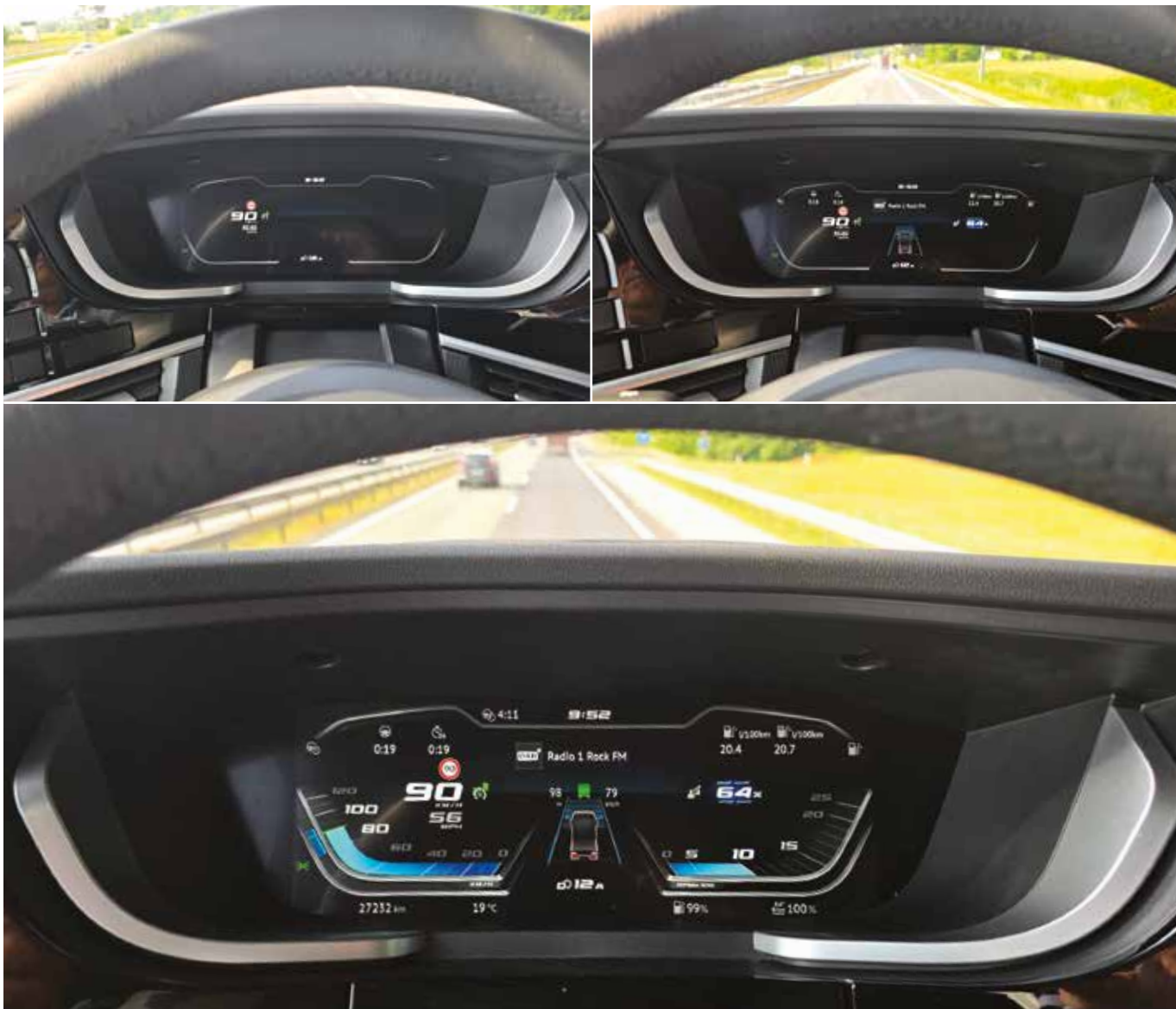
2 Sodobna digitalna plošča z merilniki omogoča različne prikaze in različno število zahtevanih informacij. Od povsem preprostega pogleda, pri katerem imamo prikazano le hitrost, do zelo sofisticiranega pogleda z množico informacij.
