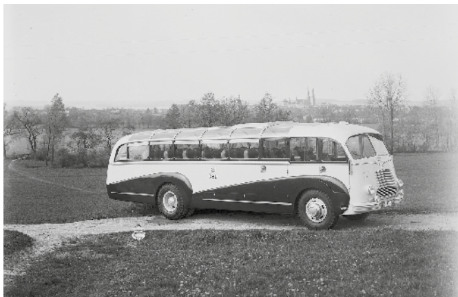
3 Leta 1948 je bila tovarna nacionalizirana in preimenovana v Karoso. Takrat so pričeli s proizvodnjo avtobusov na podvozju Škode 706 RO, kot na sliki.
