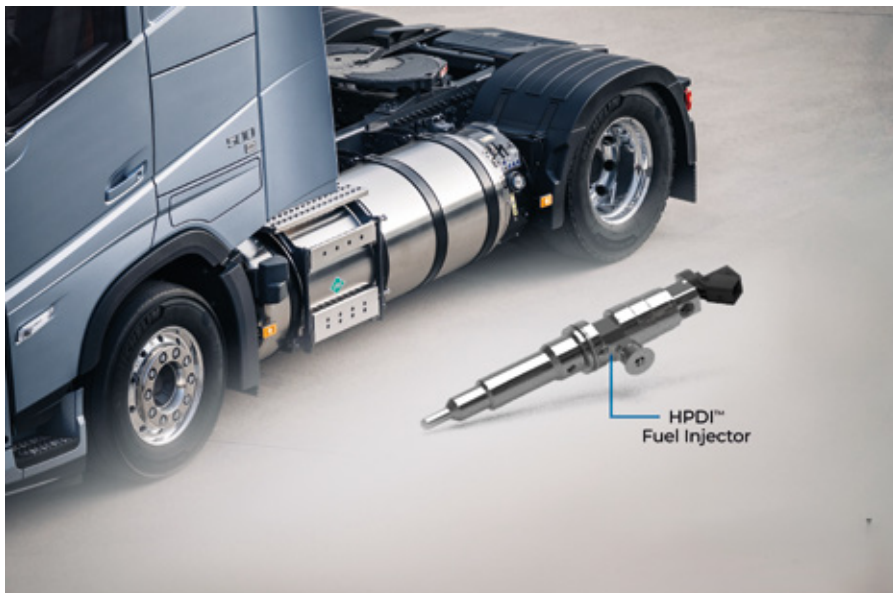
Tehnologijo H2-HPDI (visokotlačno neposredno vbrizgavanje vodika) je napovedalo podjetje Westport in se uporablja za mešanje dizla in metana.
