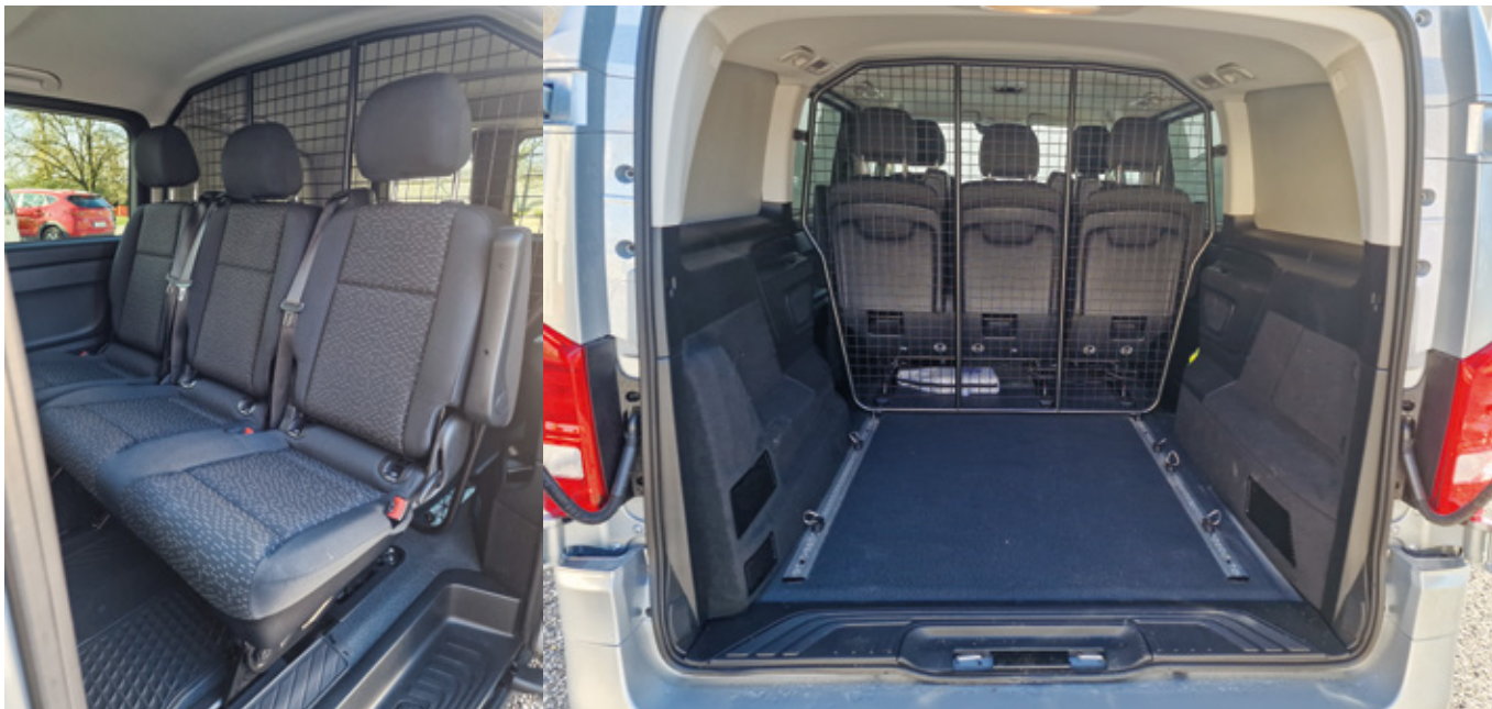
Potniški in tovorni prostor sta fizično ločena z mrežo. Tam najdemo sistem za pritrditev tovora s pomočjo pritrdilnih ušes, na katera tovor fiksiramo s trakovi.
