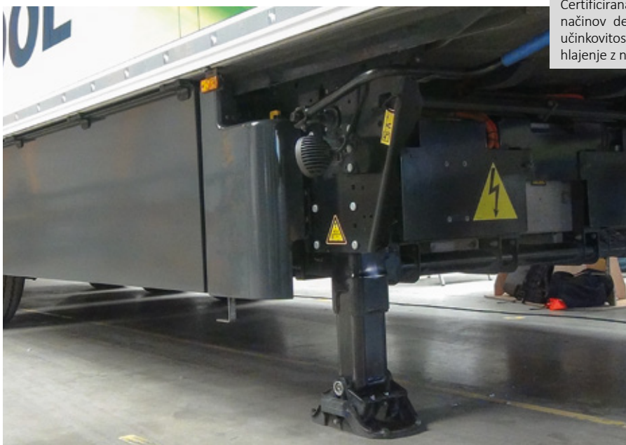
Baterije in del visokonapetostne opreme so nameščeni pod šasijo, a na drugi strani je še vedno dovolj prostora za shranjevanje palet.
