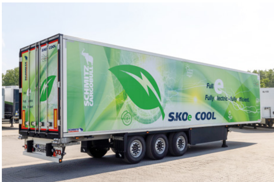
S.KOe COOL – popolnoma elektrificirana, 200 kg večje mase, a vseeno z enako nosilnostjo in enakim sistemom hlajenja, pripravljena na nove trende v industriji priklonih vozil.
