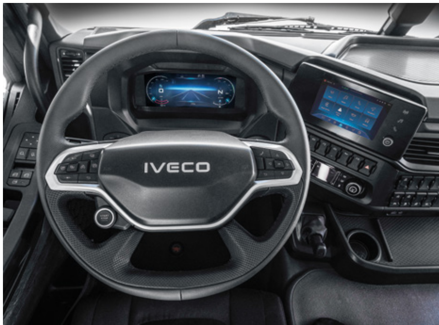
Digitalni kokpit z instrumentno ploščo TFT in nov večfunkcijski volan, na katerem je nameščen gumb stop/start.
