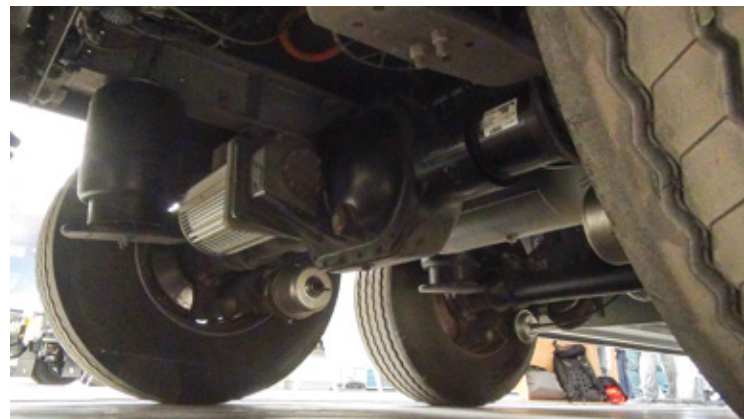
Certificirana os – generator, ki baterije polni z izbiro enega od treh načinov delovanja: Eco – maksimalna energijska in stroškovna učinkovitost; Standard – najbolj učinkovito delovanje enote za hlajenje z nizkimi stroški; Safe – največja zaščita tovora.
