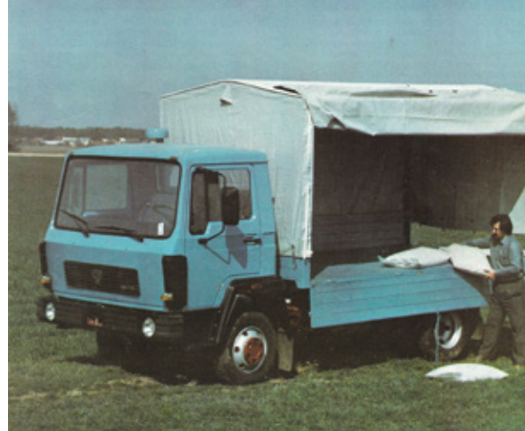
TAM 80 T 6 – najlažje različice B-programa z zračno hlajenimi torpednimi motorji se niso mogle kosati s poceni Tamičem.
