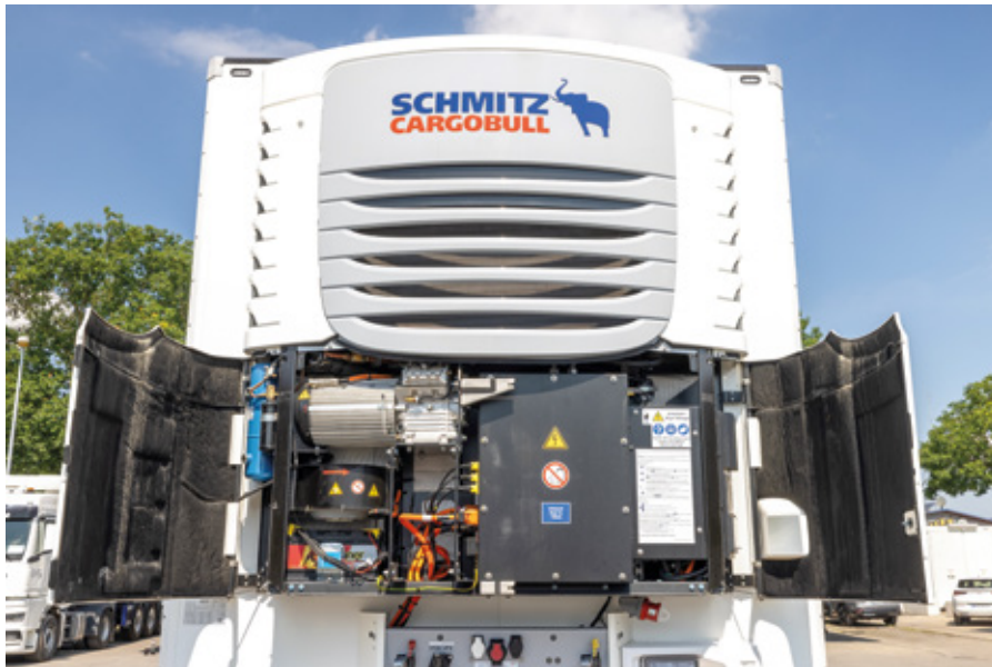
Poganja jo samo elektrika – ena od mnogih izvedb hladilnih sistemov, ki jih SCB proizvaja v svoji tovarni v Verdenu.
