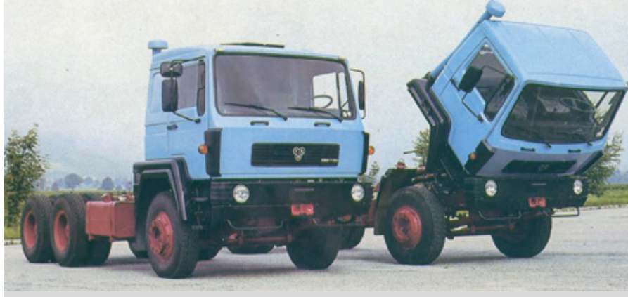
TAM 260 T 22/26 B – zaradi varčnosti so moč motorja V-8 omejili na 240 KM, nova kabina v spalni različici pa se je izkazala za pretesno za daljša potovanja.
