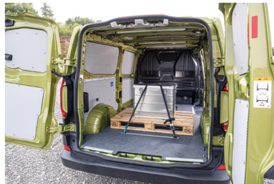
Odvisno od medosne razdalje in višine strehe novi VW Transporter ponuja od 5,8 do 9 m³ tovrnega prostora.
