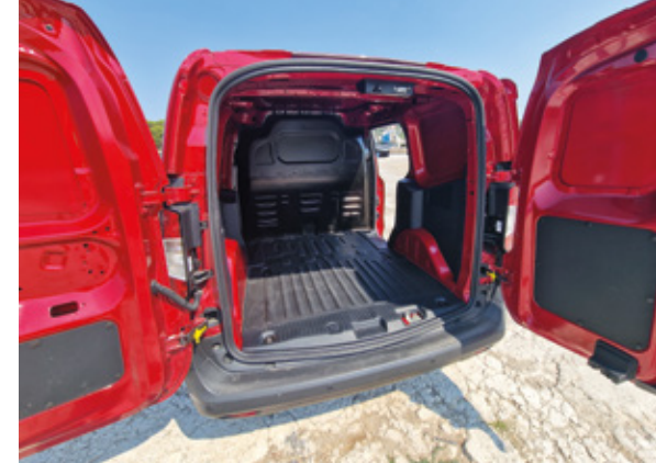
Na desnem boku so drsna vrata, tla so obložena s trdo plastiko, v pod pa je vgrajenih šest pritrditvenih ušes v skladu s standardi DIN in ISO.
