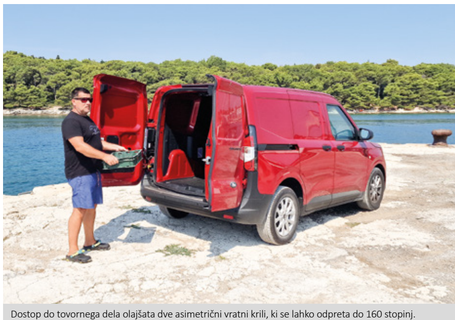
Dostop do tovornega dela olajšata dve asimetrični vratni krili, ki se lahko odpreta do 160 stopinj.
