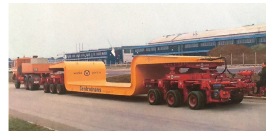
Že v zgodnji fazi svojega delovanja je podjetje Gorica ponujalo tudi priklopna vozila za prevoz posebnih tovorov z nizkim podom nakladanja (labudica) do 250 ton.
