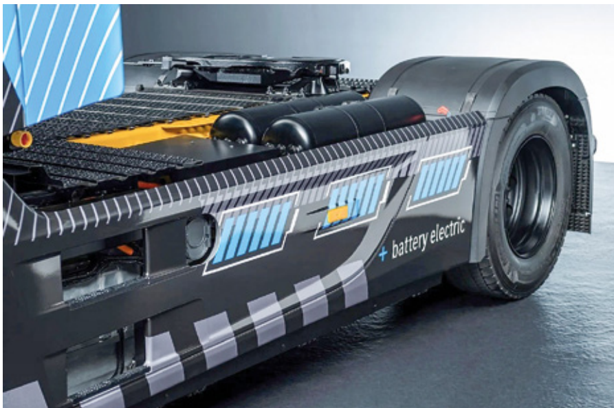
Mercedes-Benz eActros ima tri baterijske sklope, od katerih ima vsak kapaciteto 200 kWh in je težak 1,5 tone.
