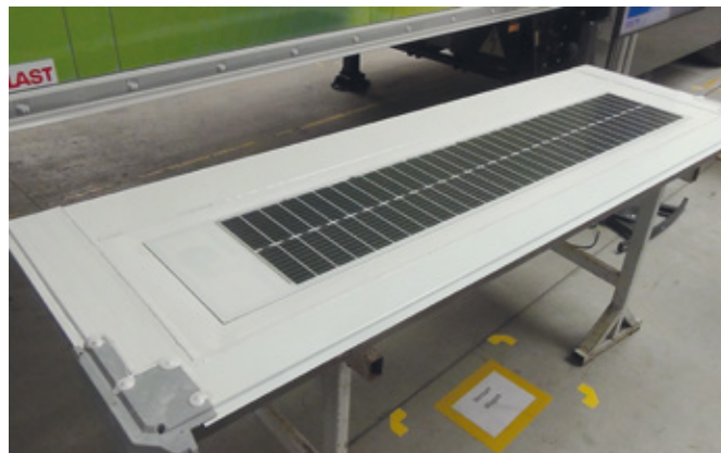
Opcijski solarni paneli na strehi hladilne polprikolice, s katerimi lahko privarčujemo oz. dopolnimo nekaj energije, ko vozilo stoji.
