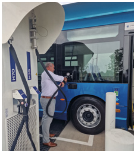
Polnilni priključek za polnjenje z vodikom pod pritiskom 350 je na obeh sprednjih delih avtobusa.
