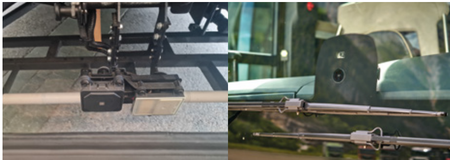
Kamera na vetrobranskem steklu zaznava in razvršča prometne znake na poti ter jih prikazuje na 12-palčnem digitalnem zaslonu. V sprednjem odbijaču pa je radarski sistem, katerega del je tudi sistem EBA+, ki lahko samodejno zaustavi avtobus od hitrosti 50 km/h, če se pred vozilom znajde kakršen koli objekt.
