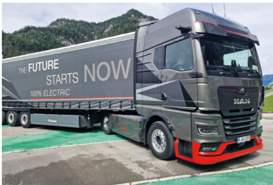
eTGX je pripravljen za uporabo. Obstajajo električni pogoni z 245, 330 ali 400 kW, zadnja dva sta kombinirana s štiristopenjskim menjalnikom. Baterija je maksimalne kapacitete: 6 x 80 kWh, tj. 480 kWh uporabne oskrbe z energijo.
