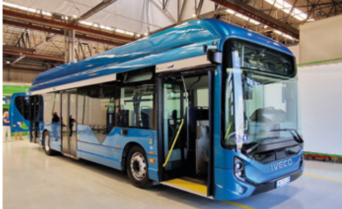
E-Way H2 je klasičen nizkopodni mestni avtobus z dolžino 12 metrov, ki za pogon uporablja gorivne celice (FCEV).
