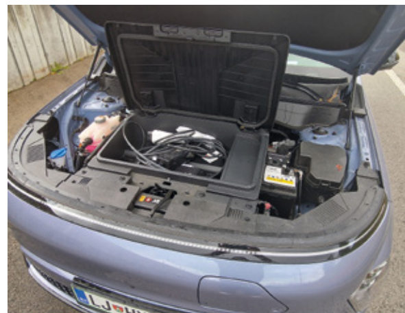
Pod sprednjim pokrovom je t.i. frunk, kamor spravimo polnilne kable, odprtina za polnjenje pa je spredaj v maski.
