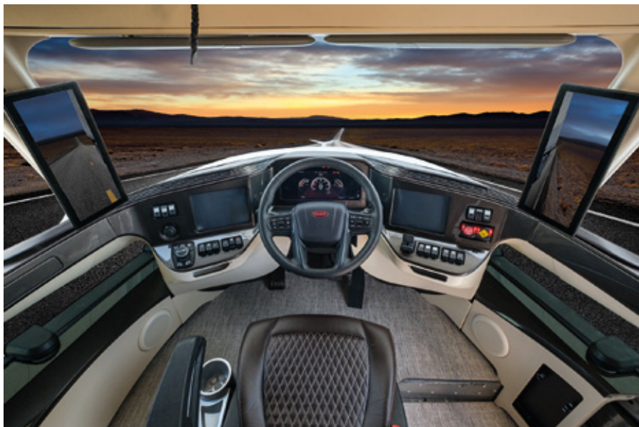
Voznikov sedež je postavljen na sredino, pred njim pa je 15-palčna digitalna instrumentna plošča.
