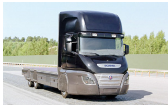
Pri snovanju celote je bil velik poudarek na aerodinamiki, zato je koncept Scanie dobil povsem novo, podolgovato prednjo masko, ki nekaj deset centimetrov štrli pred vetrobransko steklo.
