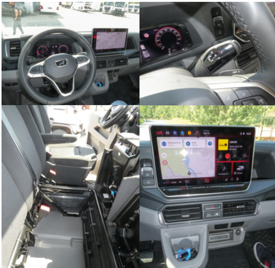
Največja novost je vsekakor digitalna armaturna plošča, na kateri si voznik lahko prilagaja prikaz in število prikazanih informacij. Ročica menjalnika je sedaj za volanskim obročem, na sredinski konzoli pa je nov ekran, občutljiv na dotik.
