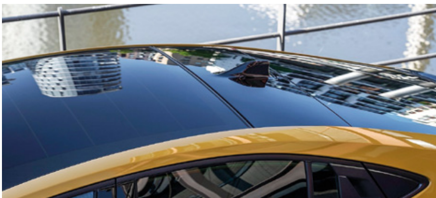
Streha je mala solarna elektrarna z izhodno močjo 185 W.
