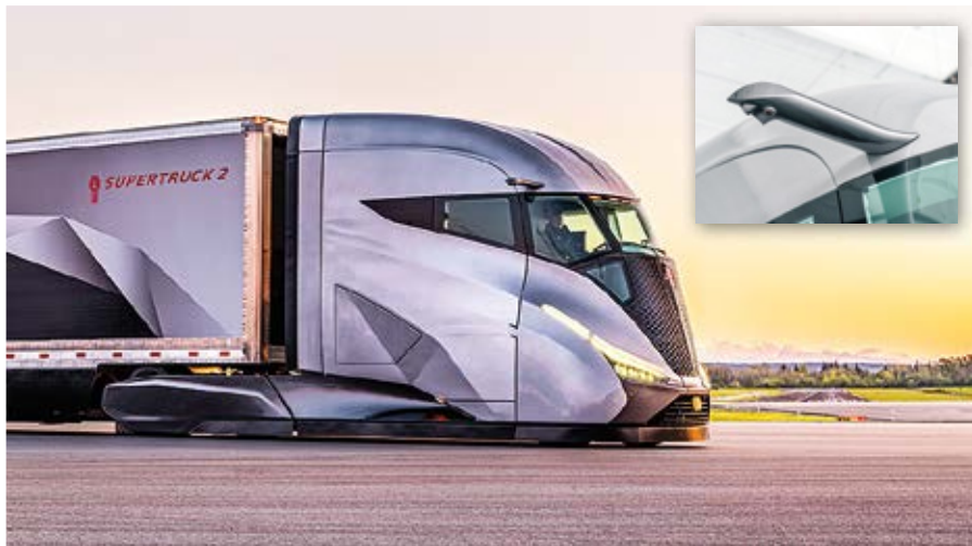
Model ima zelo klinasto, aerodinamično zasnovo in popolnoma zaprta kolesa ter kamere namesto ogledal.
