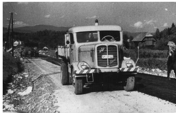
FAP 6G je bil z nosilnostjo 6 ton ter 6-valjnim dizelskim motorjem s prostornino 7982 ccm in močjo 130 KM brez prave konkurence na jugoslovanskem trgu.
