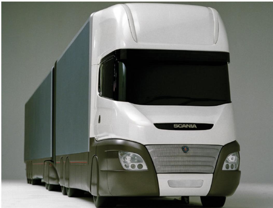
Poleg daljšega prednjega dela so Scanijini inženirji uporabili tudi obsežen aerodinamični paket za stranske površine, vključno s pokritimi kolesi vlačilca.
