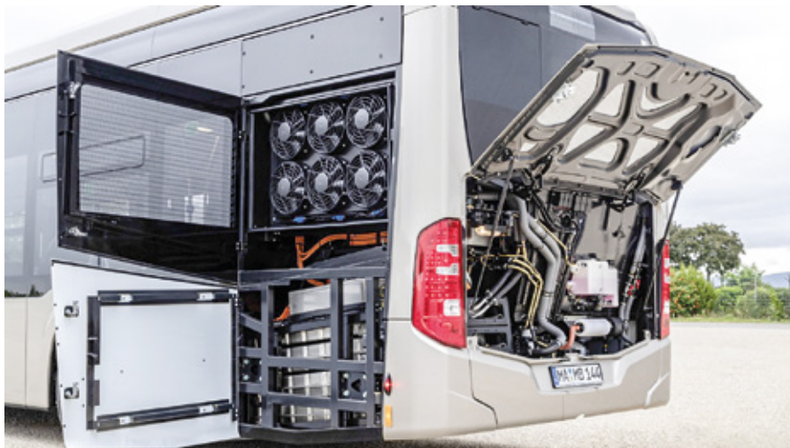
Dostopna tudi s strani: napredna tehnologija hlajenja, ki nadzoruje temperaturo izpostavljenih visokonapetostnih komponent z delovanjem, je nameščena nad zadnjimi baterijami.
