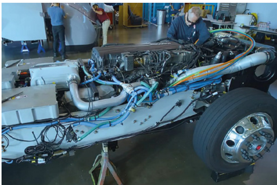
PACCAR MX-11 razvija 446 KM in ima 48-V blagi hibridni sistem, ki uporablja najnovejšo generacijo litij-ionskih baterij.
