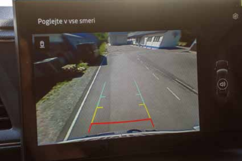
Kamera za vzvratno vožnjo ob zavijanju rotira, v sodelovanju s senzorji okrog vozila in po zaslugi dobre preglednosti, h kateri pripomorejo velika ogledala, pa je Master prijeten za manevriranje.
