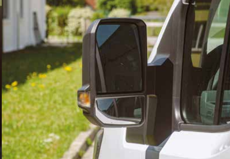
Kamera za vzvratno vožnjo ob zavijanju rotira, v sodelovanju s senzorji okrog vozila in po zaslugi dobre preglednosti, h kateri pripomorejo velika ogledala, pa je Master prijeten za manevriranje.
