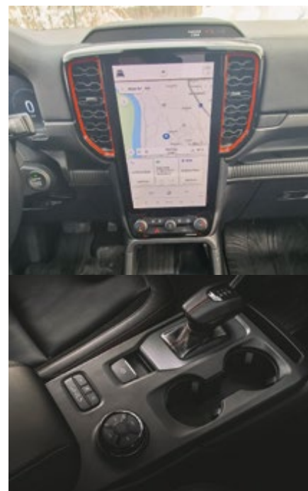
Standardno je opremljen z 12,4-palčnim digitalnim zaslonom na dotik, na katerem so vse funkcije in informacije jasno predstavljene. Ročica 10-stopenjskega samodejnega menjalnika je na sredini, tu pa je tudi vrtljivo stikalo za izbiro pogona.
