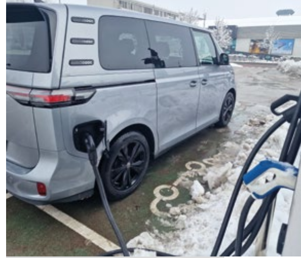
Odprtina za polnjenje je nameščena na zadnjem desnem delu vozila, elektronika pa v baterije spusti do 170 kW energije na uro.
