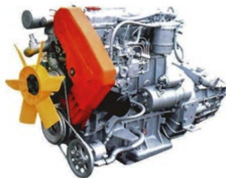
IMR S 54 – prvi jugoslovanski dizelski motor se je lahko pohvalil z za svoj čas dokaj moderno konstrukcijo. Iz 2,45 litra prostornine je izlekel 75 KM in 145 Nm, v načrtu pa so bile močnejše različice s turbinskim polnilnikom in hladilnikom polnilnega zraka, ki pa nikoli niso zaživele.
