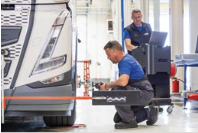
Pravilna nastavitve podvozja pri tovornih vozilih in tudi pri prikolicah je nujno potrebna za zagotavljanje varnosti, ob tem pa manjša izrabo pnevmatik in nižja porabo goriva.
