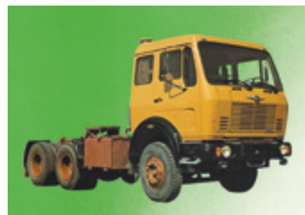
Glumac – pod moderno Mercedesovo trambus kabino se skriva konservativna tehnika FAPovega modela 15 B.
