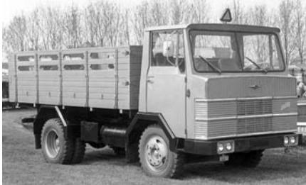
Trafika – FAP 15 B je prvo serijsko izdelano tovorno vozilo iz lastnega razvoja, ki mu je FAMOS dodal 9,5-litrski motor z močjo 160 KM. Umeščen je bil v sredino tovarniške ponudbe med Trinajstico in Bombnikom, trambus kabina pa je bila na voljo v kratki in podaljšani izvedbi.
