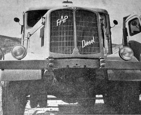
Šestak – FAP 6G z motorjem FAMOS F, šest valjev, 7.980 ccm, 130 KM, nosilnost 6 ton. Nekateri so mu zaradi dolgega nosu rekli tudi Labod.
