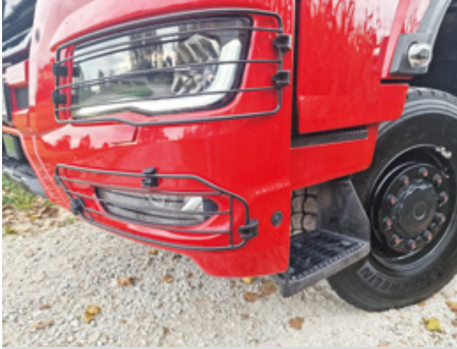
Zaradi off-road uporabe so dodatno zaščitene luči in motor, spodnja stopnica pa je gibljiva.
