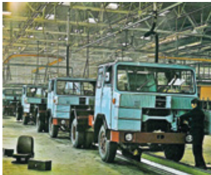
Prav nič privlačna kabina Trafike iz ravnih plošč je bila prilagojena poceni izdelavi. Namesto da bi bila izdelana v ločenem obratu, je bila kabina sestavljena neposredno na šasijo tovornjaka.
