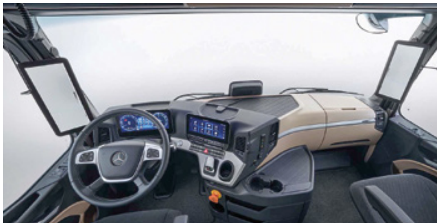
Notranjost popolnoma električnega tovornjaka ima precej običajno postavitev, z digitalno armaturo in zaslonoma na A stebričku, ki prikazujeta dogajanje za vozilom in okoli njega.
