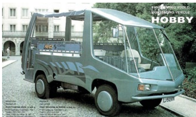
Avtomontaža Hobby – Tomosov oblikovalec Igor Rosa je leta 1985 razvil odprti turistični minibus na podvozju »Tamiča«. Kasneje je proizvodnjo tega modela s plastično karoserijo, ojačano z jekleno podkonstrukcijo, prevzela Avtomontaža iz Ljubljane, poleg »Tamičeve« osnove pa je bila ponujena tudi različica na šasiji Zastava 35.8. S skupno težo 3,5 t in kapaciteto potnikov 8+1 je bilo to vozilo mogoče voziti z vozniškim dovoljenjem B kategorije.
