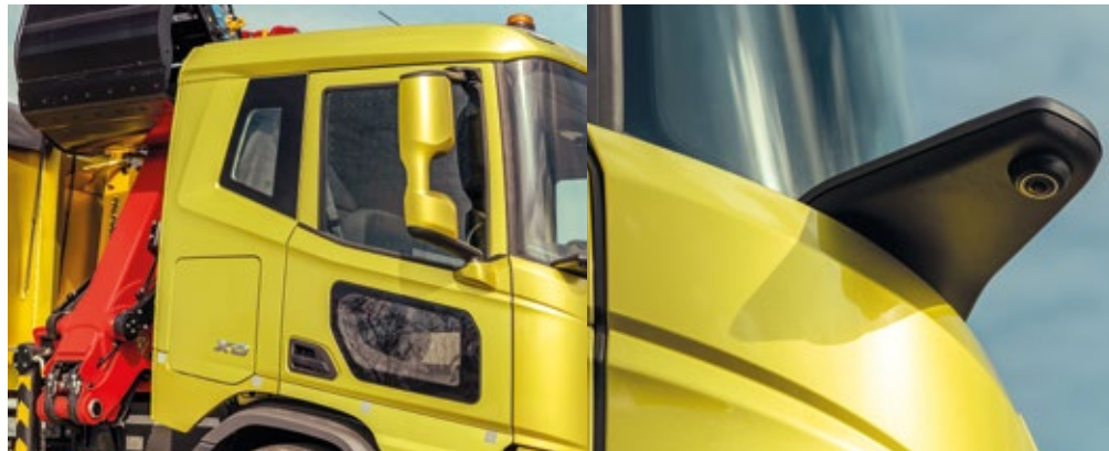
Različni detajli, kot sta denimo okno v spodnjem delu sovoznikovih vrat ali sistem kamer, ki zmanjšujejo mrtve kote, prispevajo k večji varnosti in okretnosti.
