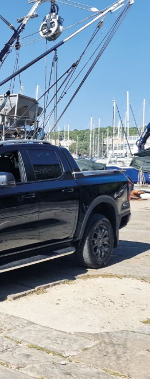
Očiten je skrajšan prednji previs. Sprednja kolesa so premaknjena bolj naprej in tako je podaljšana medosna razdalja.
