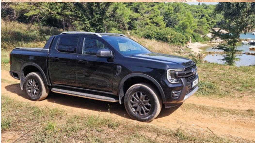
Očiten je skrajšan prednji previs. Sprednja kolesa so premaknjena bolj naprej in tako je podaljšana medosna razdalja.
