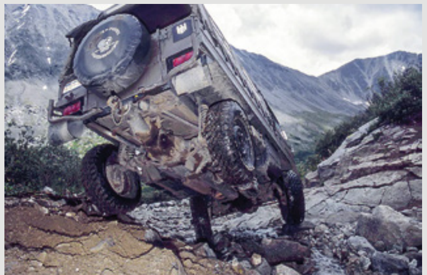
S pomočjo ročic v kabini je bilo možno mehansko zakleniti vse diferenciale.
