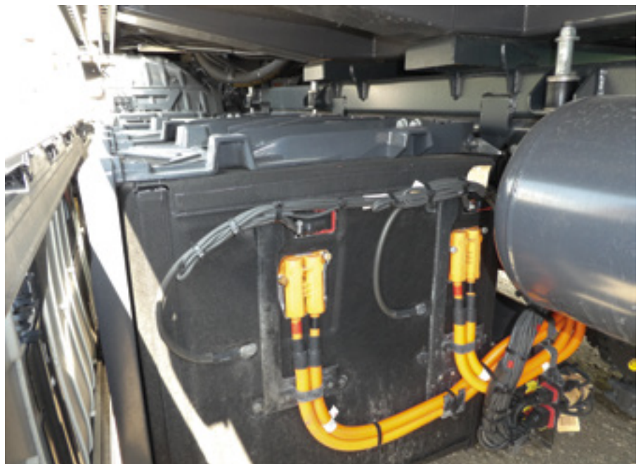
Baterije so nameščene na boku, kjer bi bila sicer posoda za gorivo in AdBlue.
