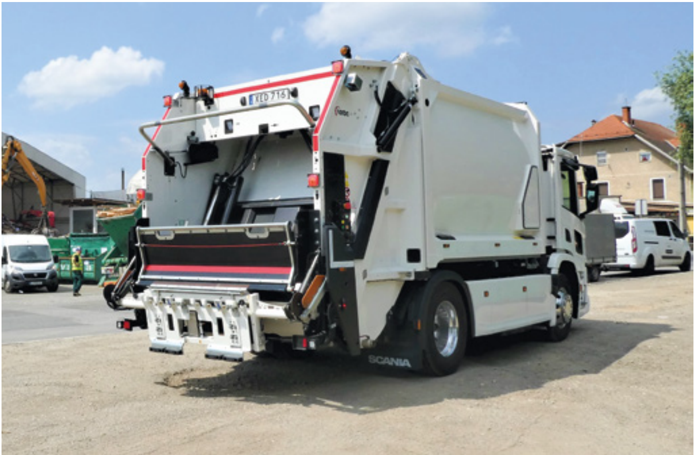
Tiho pobiranje smeti v jutranjih urah, saj s pomočjo elektrike deluje tudi nadgradnja.
