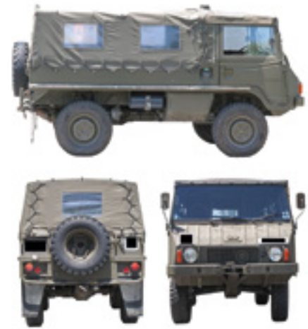
Zanimiva konstrukcija visoke in ozke silhuete, a je močna in težka šasija zniževala težišče.
