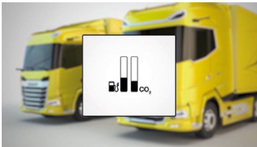
Vecto je oblika programske opreme, ki simulira izpuste CO 2 in porabo goriva za katero koli dano kombinacijo tovornih vozil na podlagi podatkov, ki jih vnese proizvajalec.
