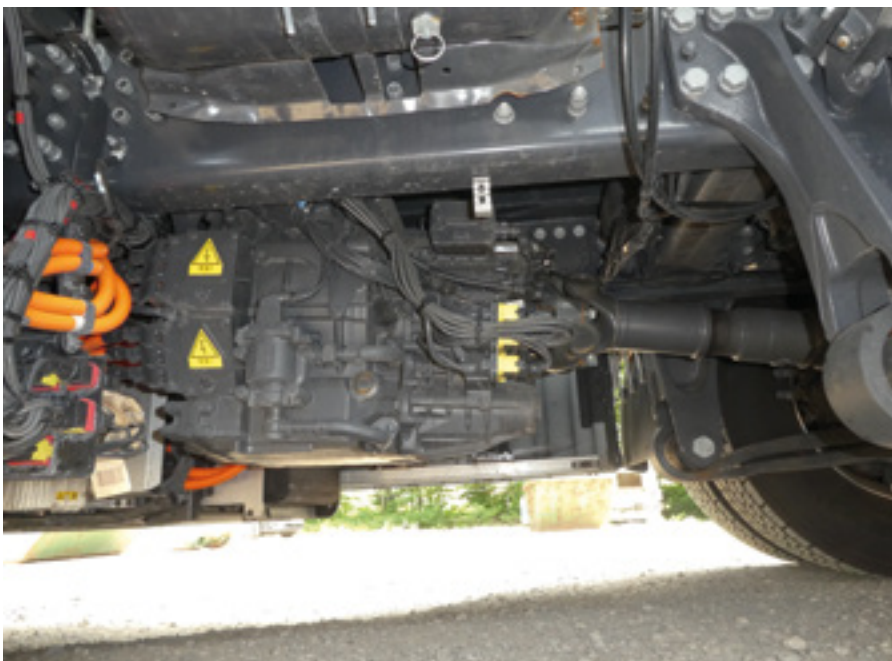
Elektro motor je nameščen tik pred zadnjo osjo in z njo povezan preko kardana.
