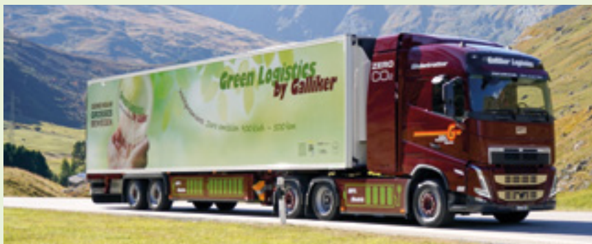
Z največjim ekološkim učinkom: kombinacija Futuricumovega električnega vlačilca in hladilne polpriklolice SR2.
