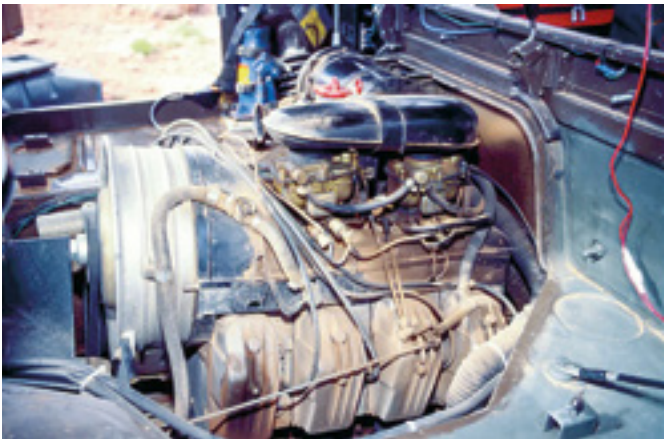
Spredaj nameščen 2,5-litrski štirivaljni zračno hlajen motor z močjo 88 KM in 180 Nm navora.
