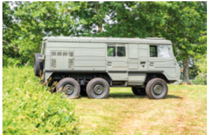
Izvedba 6x6 z oznako 712 je imela dodatno pogonsko os in listnate vzmeti in je bila za 80 centimetrov daljša.
