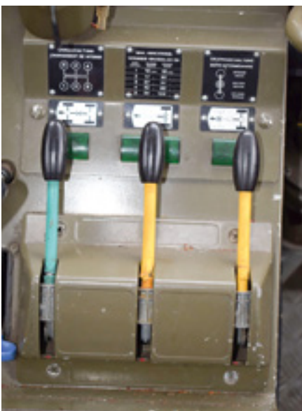
S pomočjo ročic v kabini je bilo možno mehansko zakleniti vse diferenciale.
