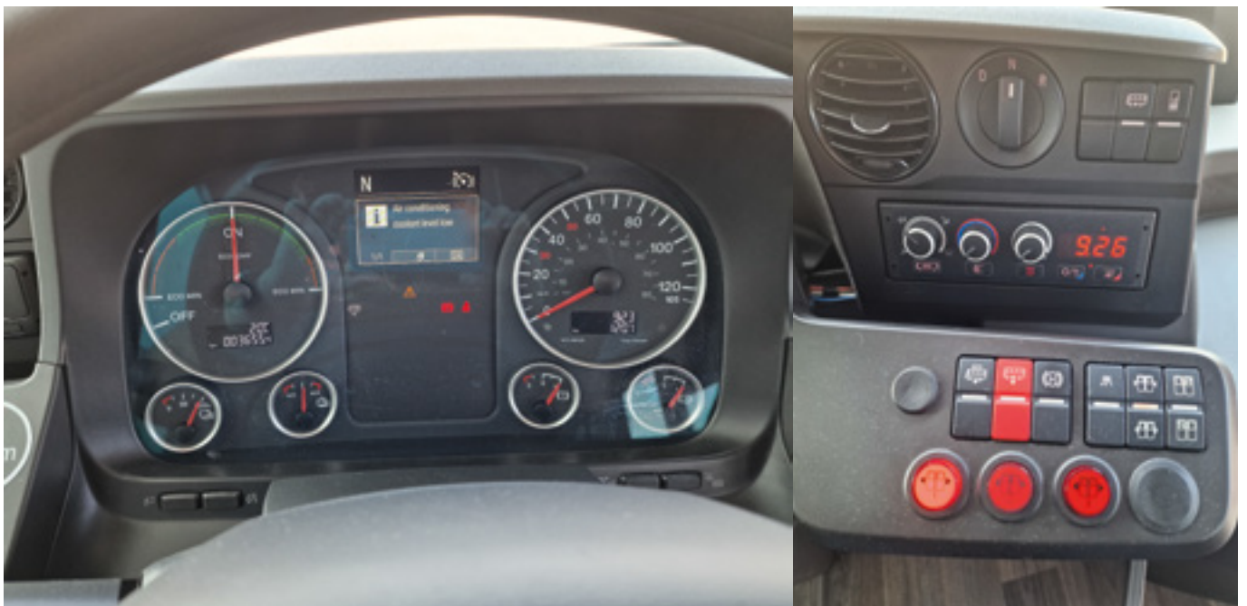
Značilna MANova stikala in merilniki z dodatnim podatkom o stanju baterij in načinu vožnje.
