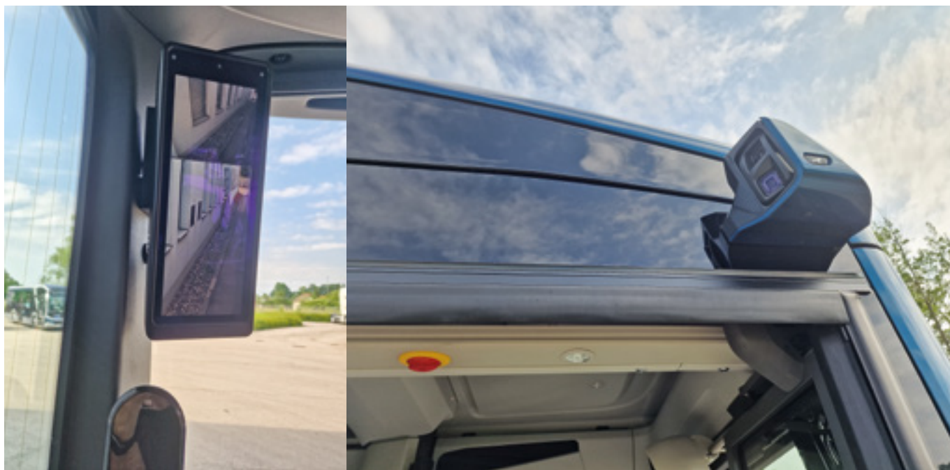
Nekaj dinamike pri videzu gre tudi na račun sistema OptiView, ki namesto klasičnih zunanjih ogledal uporablja kamere za spremljanje dogajanja za vozilom in ob njem.
