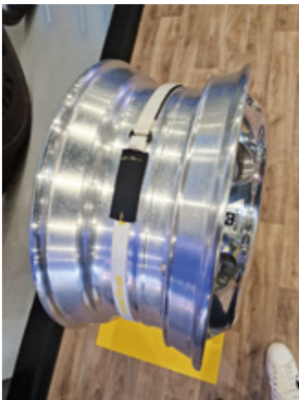
Goodyear DrivePoint je avtomatiziran sistem za natančno preverjanje tlaka v pnevmatikah.
