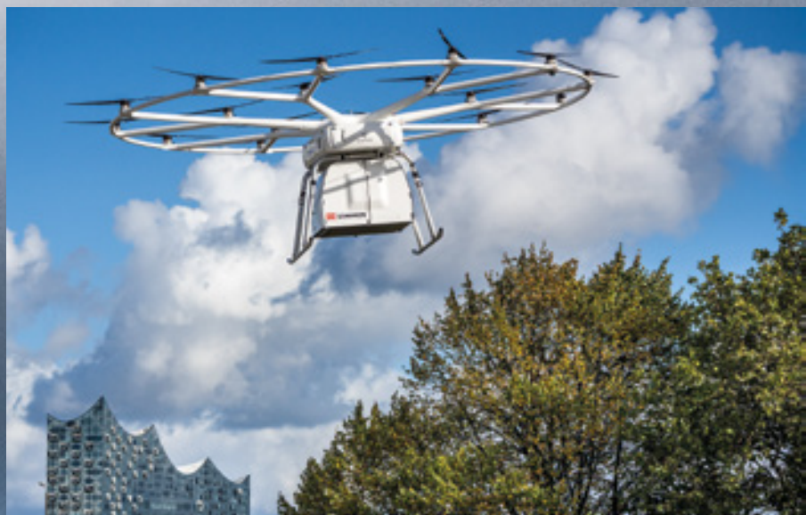
Nova transportna »galaksija«: VoloDrone – električni dron, prilagojen za prevoz standardne palete s tovorom do 200 kg teže na razdalji do 40 km.
