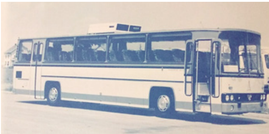
TAM-Magirus 232 A 12 – Avtomontažina karoserija v enakem dizajnu kot modeli TAM je bila na voljo tudi na daljši šasiji Magirus z močnejšim motorjem.
