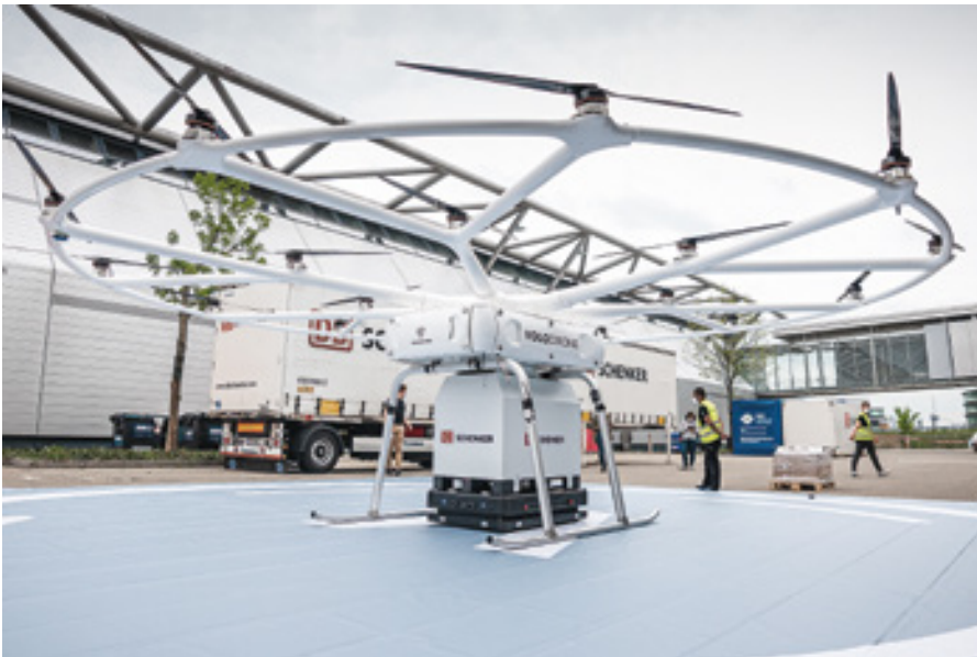
Tovor, ki ga prevažata prvi težji dron, je spravljen v posebno »kontejnersko« škatlo, ki za lažjo manipulacijo »leži« na standardni leseni ali plastični evro paleti.
