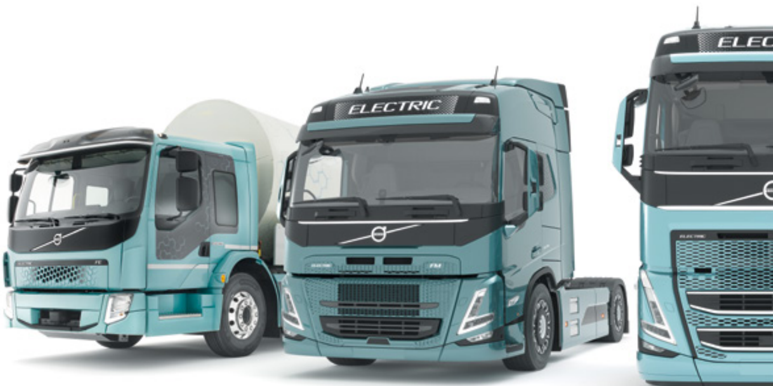
Električna vozila so praktično brezšumna, vendar morajo po zakonu do hitrosti 30 km/h proizvajati umeten zvok.
