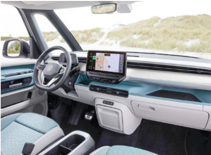
Za velikim multifunkcijskim volanom je majhna informacijska plošča, na desni strani pa je nameščena ročica za vzpostavitev pogona naprej ali nazaj.
