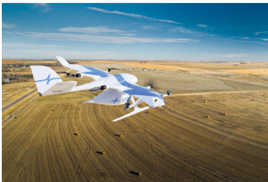
Wingcopter 198 vzleta in pristaja kot majhna, že udomačena brezpilotna letala, velike razdalje pa premaguje hitro in učinkovito – kot letalo s krili.
