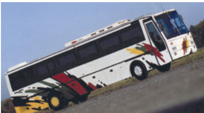
TAM 260 za ameriški trg je bil opremljen z 8,3-litrskim vodno hlajenim motorjem Cummins, ki je s turbinskim polnilnikom razvijal 275 KM. Moč je prenašal 5-stopenjski samodejni menjalnik ZF z retarderjem, zračne zavore je proizvajal Rockwell, samodejna klimatska naprava je prihajala od podjetja Sutrak ...
