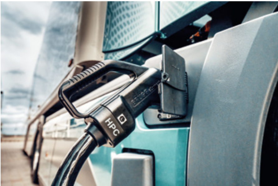
Volvo ponuja različne načine polnjenja, in sicer z dvosmernim tokom do moči 43 kW in enosmernim tokom do moči 250 kW.
