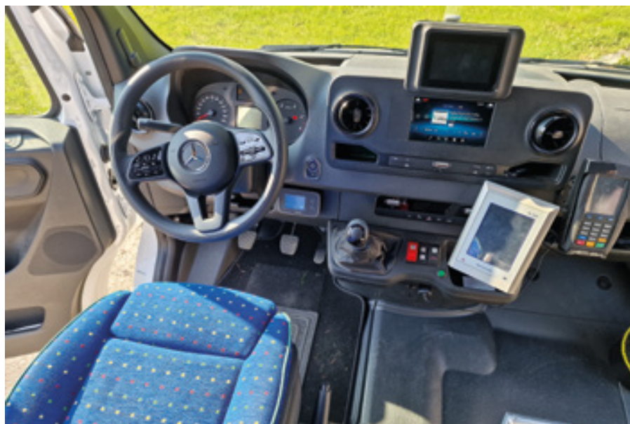
Voznikov delovni prostor je enak kot pri osnovnem Sprinterju, dodana pa so stikala za odpiranje vrat, prezračevanje v zadnjem delu ter sistem za kontrolo vozovnic.
