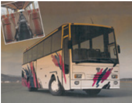
TAM 331 A 119 VT – nadgrajena različica najnovejšega modela je ponovno uporabljala motor KHD, ki je z večjo delovno prostornino 13.382 ccm in turbinskim polnilnikom zagotavljal 330 KM in 1225 Nm.
