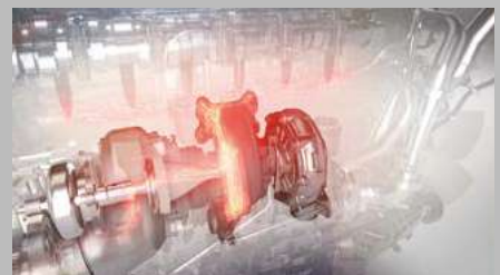
Presežek energije v izpušnih plinih se rekuperira in ponovno uporabi v TurboCompound enoti.
