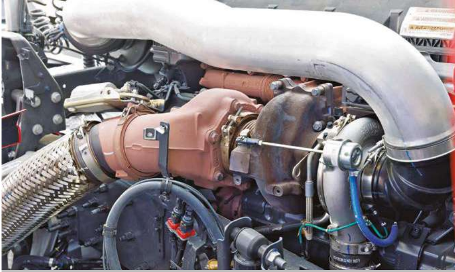
TurboCompound je začetek verige okolščin, ki nastanejo z njegovo vključitvijo v pogon, med katerimi je nedvomno najpomembnejše povečanje motornega navora.
