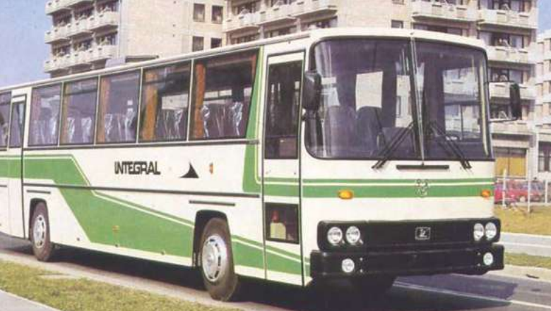
TAM 260 A 120 T – prvi model na novi platformi z zračnim vzmetenjem in motorjem V-8 se je pojavil leta 1983 na znani karoseriji Avtomontaže, ki je bila prilagojena povečani dolžini na 12 metrov in višini 3,15 metra. Tako je nastal prostor za dodatno vrsto potniških sedežev in večji prtljažnik, ta model pa je bil serijsko opremljen z enokrilnimi vhodnimi vrati.
