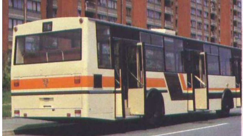
Edinstveni prototip je imel številne rešitve, podobne takratnim turističnim avtobusom, kot je zasnova velikih oken ali strešnih prezračevalnih odprtin. Serijski model z manjšimi stekli in drugačno svetlobno signalizacijo je bil precej poenostavljen.
