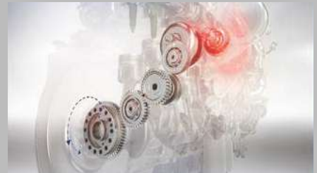
Rekuperirana energija se prenese na motorno gred prek sistema zobnikov, kar daje motorju dodatno moč.
