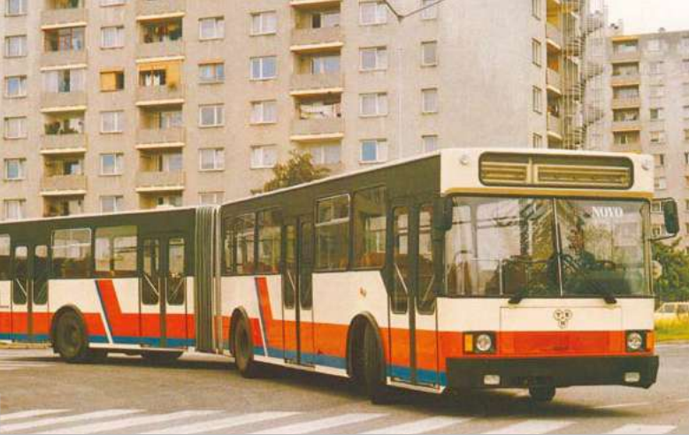
TAM 260 A 180 M – prototip zgibne izvedbe je leta 1985 presenetil s konceptom, po katerem »prikolica potiska prednji del«, ki ga je takrat uporabljal le Mercedes. Uporabljen je bil tudi sistem ogrevanja notranjosti, ki izkorišča sproščeno toploto avtomatskega menjalnika.
