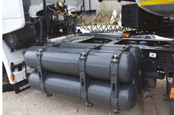
Posode za plin sprejmejo 200 kg stisnjene zemeljskega plina, kar v povprečnih pogojih zagotavlja avtonomijo 600–700 km.
