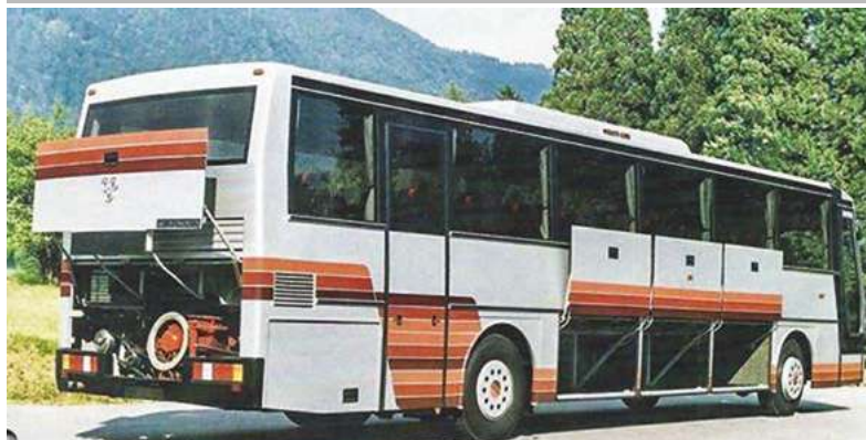
Posebnost je bila vzporedno odpiranje prtljažnika in pokrovov motorja, takrat precej redka rešitev.
