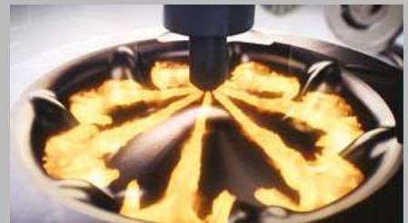
Bat je proti robu izdelan v obliki sedmih valov, ki usmerjajo plamen nazaj proti središču komore, tako je zgorevanje bolj popolno.
