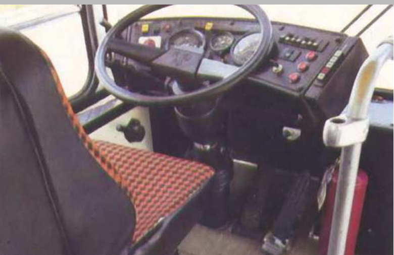
Koncept novega TAMovega mestnega avtobusa se je v veliki meri spogledoval s sodobno zahodno konkurenco, vključno z ergonomsko armaturno ploščo in možnostjo vgradnje samodejnega menjalnika.
