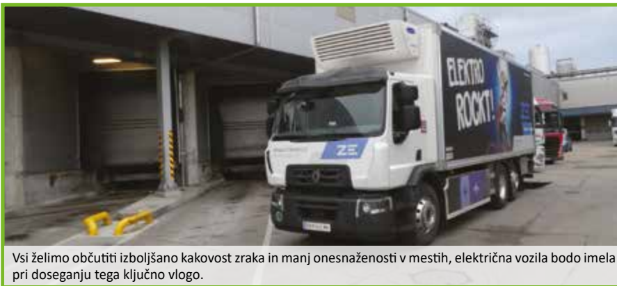
Hladilna nadgradnja ima zunanjo dolžino 7,6 m, na njej pa so zadnja vrata z gumiranimi zavesami za hitri vstop in dvižno ploščadjo z zmogljivostjo 1500 kg.
