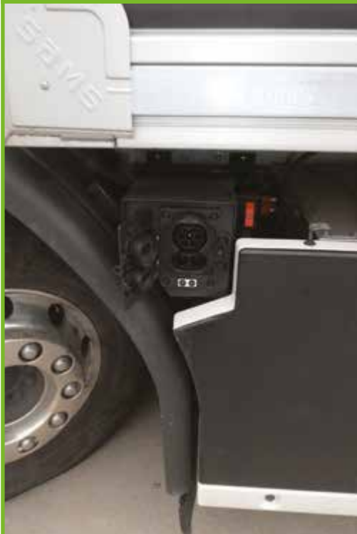
Baterijski sklop je sestavljen iz 4 paketov baterij s kapaciteto 66 kWh, skupaj 264 kWh. Baterije so nameščene na šasiji v medosnem prostoru, kjer bi sicer bila nameščena posoda za gorivo.
