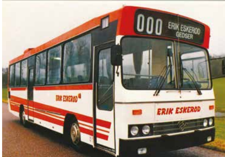
TAM 190A11P je na danskem trgu konkuriral z zračno hlajenim motorjem in z listnatimi vzmetmi.
