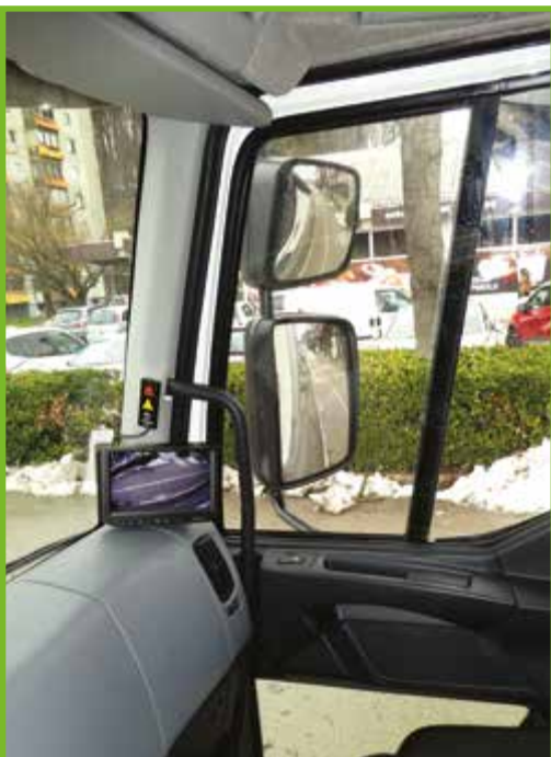
Na seznamu varnostne opreme je senzor za nadziranje mrtvega kota na desni strani ter dodatno okno v sovoznikovih vratih, ki prav tako zmanjšuje mrtve kote.
