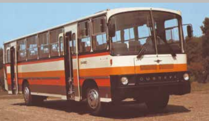
FAP-Sanos S 411 – krajša različica z motorjem in osmi tovornega vozila Mercedes
