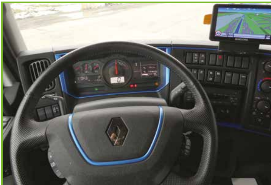
Notranjost se ne razlikuje veliko od klasičnega tovornjaka. Na volanu in merilnikih je nekaj modrih dodatkov. Razliko opazimo tudi v detajlu, kjer je klasični merilec vrtljajev odstopil prostor merilniku moči. Ta prikazuje, kdaj baterije poganjajo elektromotor oz. kdaj se polnijo (ob zaviranju). Ves čas lahko tudi spremljate preostali odstotek baterije in kakšen je še doseg vozila.
