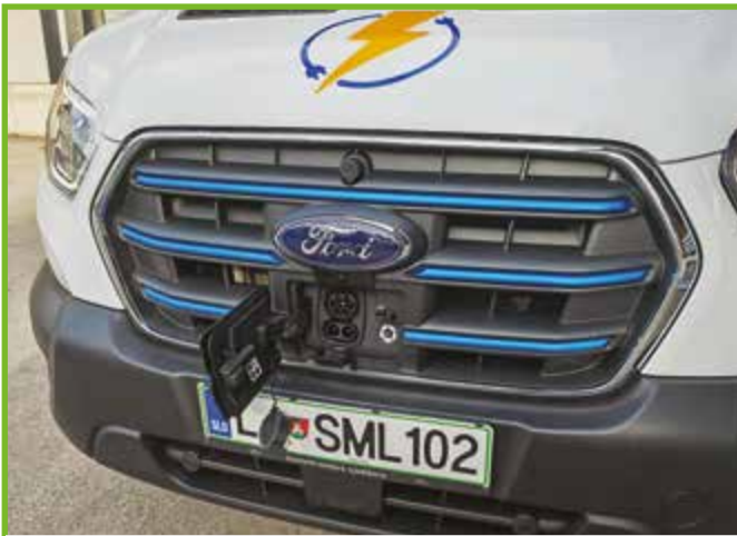
Ford je za polnilni priključek izbral najbolj optimalno mesto, in sicer v sredini maske.
