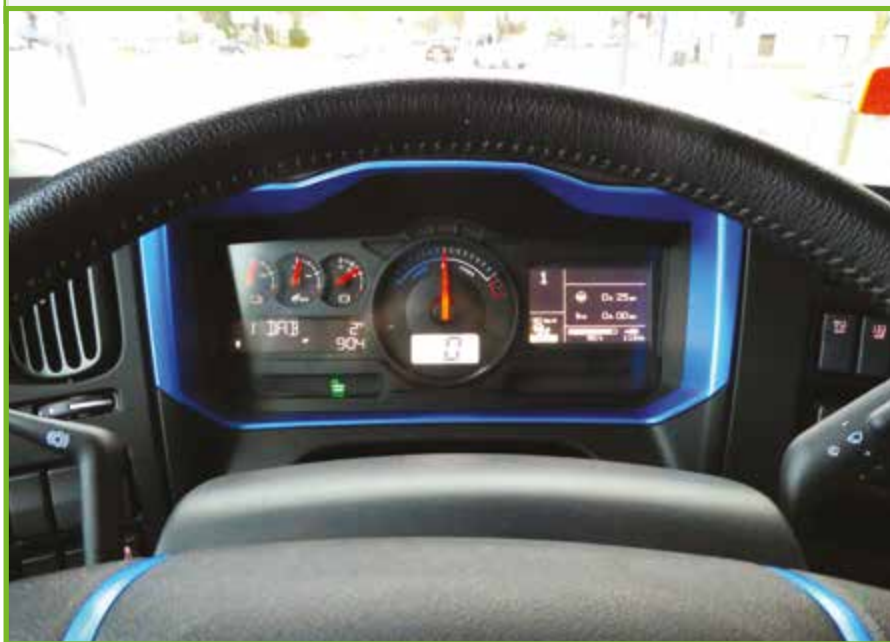
Notranjost se ne razlikuje veliko od klasičnega tovornjaka. Na volanu in merilnikih je nekaj modrih dodatkov. Razliko opazimo tudi v detajlu, kjer je klasični merilec vrtljajev odstopil prostor merilniku moči. Ta prikazuje, kdaj baterije poganjajo elektromotor oz. kdaj se polnijo (ob zaviranju). Ves čas lahko tudi spremljate preostali odstotek baterije in kakšen je še doseg vozila.
