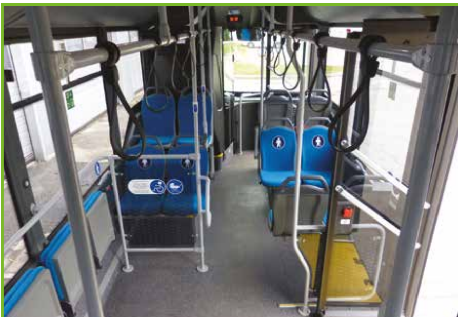
Kljub manjši širini so v vrsti vseeno štirje potniški sedeži. Možna je vgradnja 19–25 sedežev (26–33 stojšč), od katerih so štirje zložljivi v prosti prostor nasproti centralnega vhoda, ki je namenjen invalidskim ali otroškim vozičkom.
