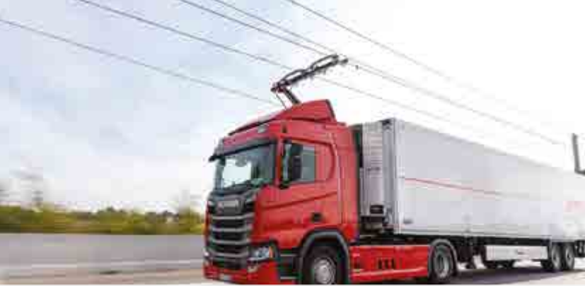
Scania poskuša s svojim modelom, kjer je tovornjak na cesti priklopljen na omrežje podobno kot trolejbus.
