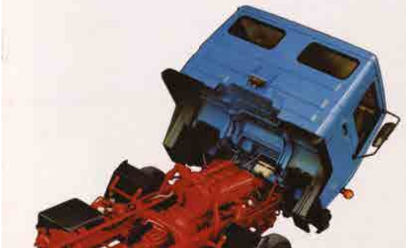
Prekucna trambus kabina lastne konstrukcije je olajšala pristop k motorju pri morebitnem popravilu.
