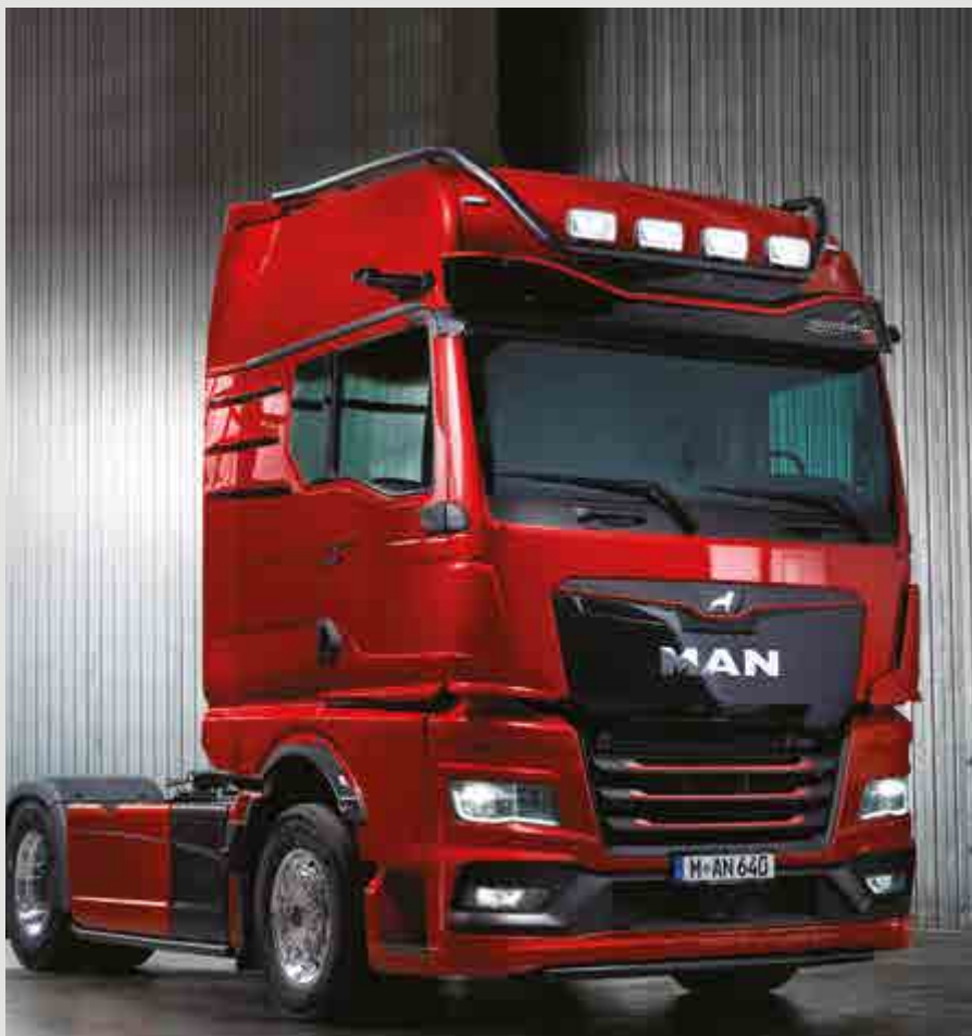
MANov najzmogljivejši vlačilec TGX 18.640 po »dodelavi« v modifikacijskem centru: spremembe so dobro opazne – od maske prek dodatkov na strešnem spojlerju do inox blatnikov.
