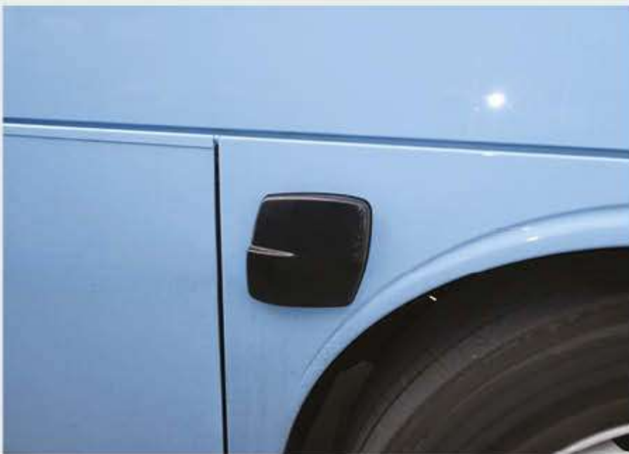
Na boku so nameščeni senzorji Sideguard Assist, sistem za pomoč pri zavijanju v desno.
