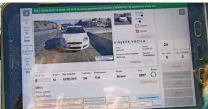
Kontrola vinjet na cesti, pri kateri sistem prepozna vozilo in registrsko tablico ter v trenutku operaterju sporoči, ali ima vozilo veljavno e-vinjeto ali ne.
