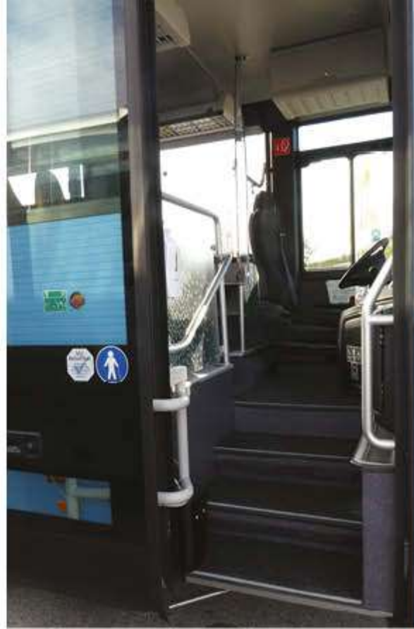
Spredaj vstopamo v avtobus skozi slab meter široka enojna vrata, zadaj pa skozi 1,4 metra široka dvokrilna vrata.
