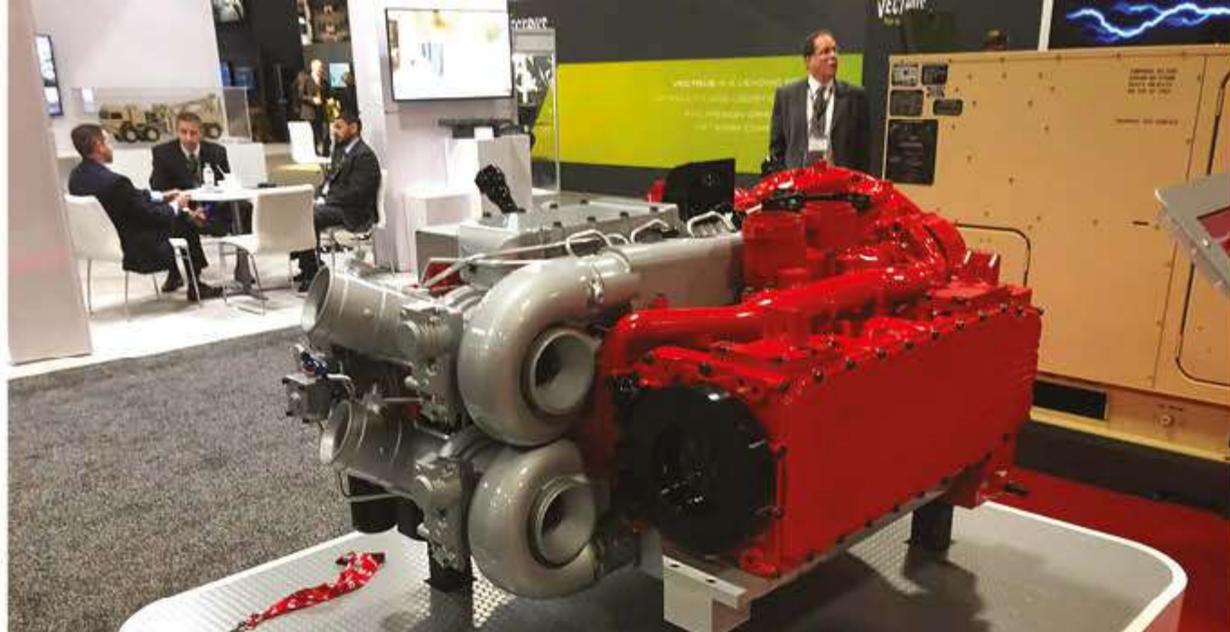
Motor je nižji, kompaktnější in lažji. Čeprav gre za horizontalno zasnovan motor, se razlikuje tudi od bokerskega motorja, ki je v bistvu le V-motor s 180-stopinjskim kotom med dvema vrstama valjev.
