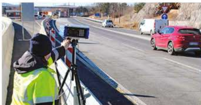
Kontrola vinjet na cesti, pri kateri sistem prepozna vozilo in registrsko tablico ter v trenutku operaterju sporoči, ali ima vozilo veljavno e-vinjeto ali ne.
