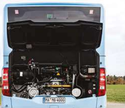
Povsem zadaj je nameščen OM 936, Euro VI D, šestvaljni, vrstni motor s prostornino 7698 cm 3 .
