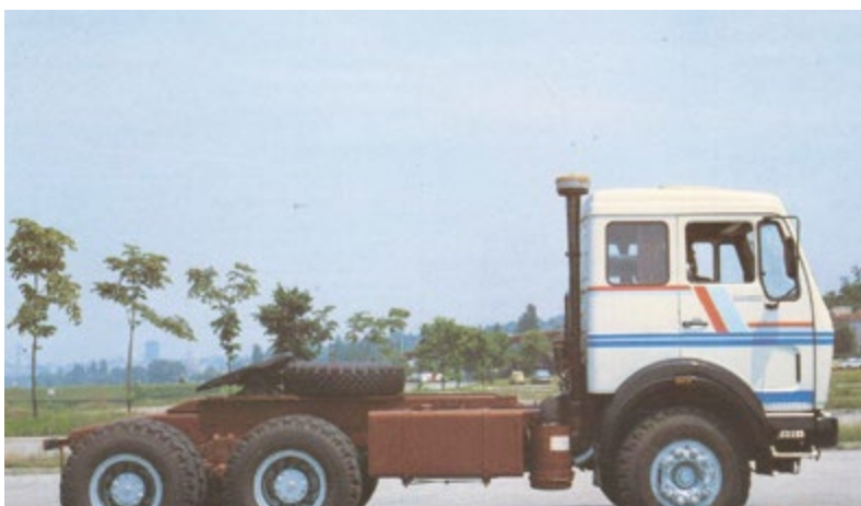
FAP 2632 VBTD 6x4 – tovrstnega mišičnjaka z Mercedesovim motorjem OM 403 smo redko srečali na cestah, kot tudi FAPA s kabino, ki ni bila v značilni rumeni barvi.
