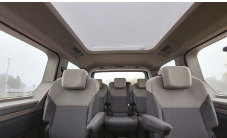
V vozilu so tri sedežne vrste. Konfiguracija sedežev je lahko 2+2+3. Sedeži so zdaj prav vsi posamični in jih je možno vzdolžno prestavljati po kabini. So precej lažji kot prej, no, zaradi teže 22 kg jih še vedno ni najbolj enostavno odstraniti iz vozila. Celotna notranjost je osvetljena z LED lučmi, ponoči je na voljo očem ugodna ambientalna osvetlitev, za vsako sedežno vrsto pa si je možno nastaviti tudi prezračevanje in/ali ogrevanje.
