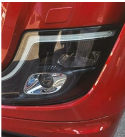
Na novo oblikovani LED žarometi imajo večjo svetilnost od kesonskih in bolje osvetljujejo pot, imajo pa tudi daljšo življenjsko dobo ter so energijsko učinkovitejši.
