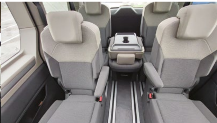
V vozilu so tri sedežne vrste. Konfiguracija sedežev je lahko 2+2+3. Sedeži so zdaj prav vsi posamični in jih je možno vzdolžno prestavljati po kabini. So precej lažji kot prej, no, zaradi teže 22 kg jih še vedno ni najbolj enostavno odstraniti iz vozila. Celotna notranjost je osvetljena z LED lučmi, ponoči je na voljo očem ugodna ambientalna osvetlitev, za vsako sedežno vrsto pa si je možno nastaviti tudi prezračevanje in/ali ogrevanje.
