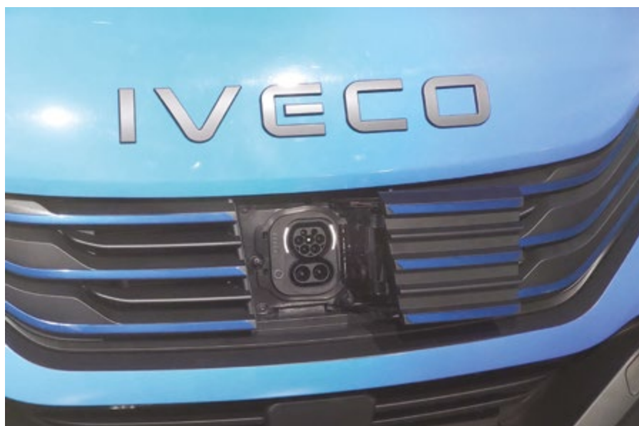
Prilok za polnjenje je nameščen v sredini maske.
