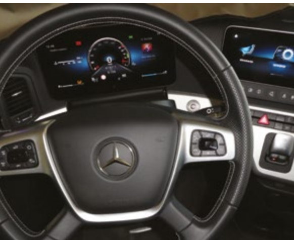
Multifunkcijski volan, pri katerem s stikali na levem kraku krmilimo funkcije na plošči z merilniki, s stikali na desnem kraku pa funkcije na osrednjem zaslonu.
