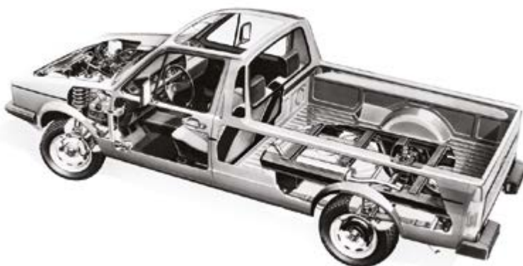
Tehnološki koncept je bil prevzet od Volkswagnove ameriške podružnice, skupaj s togo zadnjo osjo z listnatimi vzmetmi. Podaljšano medosje je ob skrajšani kabini poskrbelo za 1,83 m dolg tovarni prostor.
