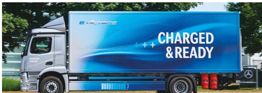
Vozilo uporablja dva integrirana elektromotorja in dvostopenjski menjalnik, kar nudi največjo stalno moč 330 kW ali prevedeno 449 km.
