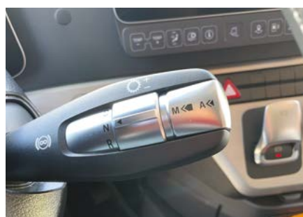
S pomočjo ročice, ki v klasičnem Actrosu služi za uravnavanje retarderja, nastavljamo intenzivnost samodejnega zaviranja in rekuperacije.
