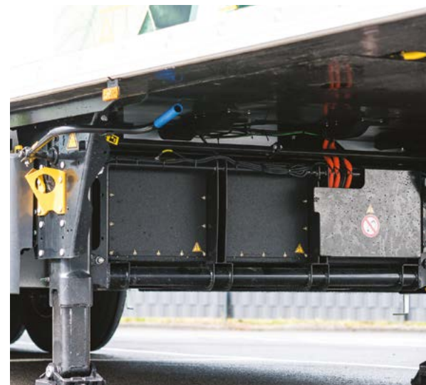
S.KOe COOL je poleg hladilne enote S.CUe opremljen tudi z energetske elektrono, ki »usklajuje« delovanje akumulatorskega sistema.
