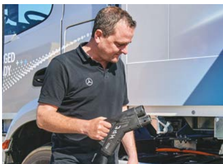
Za polnjenje je ob strani nameščen klasičen CCS priključek, s katerim lahko prek 400-V sistema eActros prejme največ 160 kW moči.
