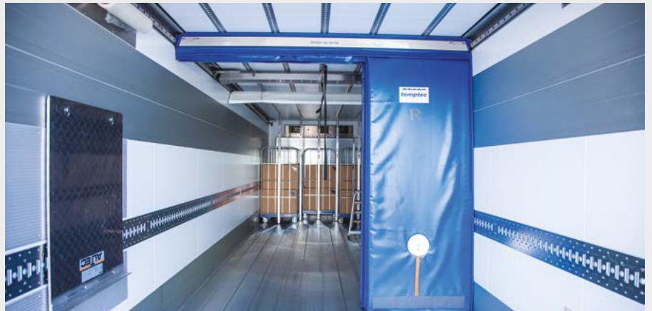
Zavesa za pregrajevanje tovornega dela ima magnetno fiksacijo in omogoča učinkovitejšo izrabo hladilnega agregata.
