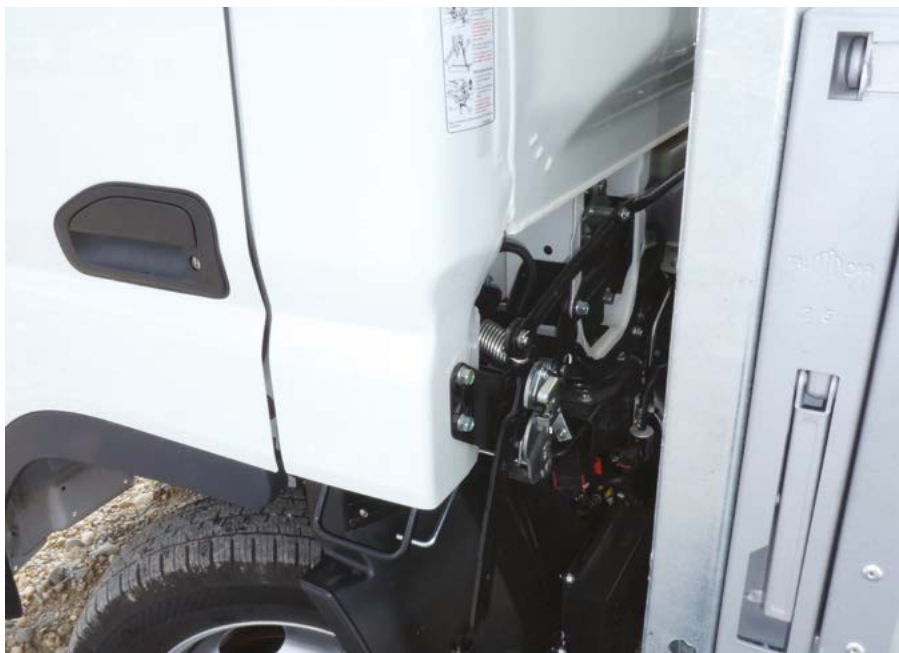
Kabina se mehansko prekucne naprej in omogoča preprost dostop do motorja za morebitna popravila.
