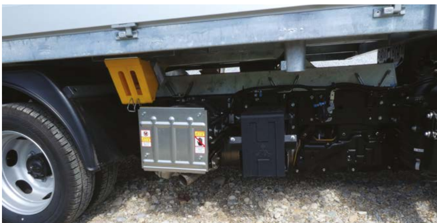
Vsi dodatni sistemi, kakor tudi katalizator, se nahajajo na šasiji vozila.
