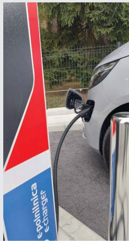
Priklop za polnjenje je v levem delu odbijača. Samo polnjenje pa je odvisno od moči polnilnice.
