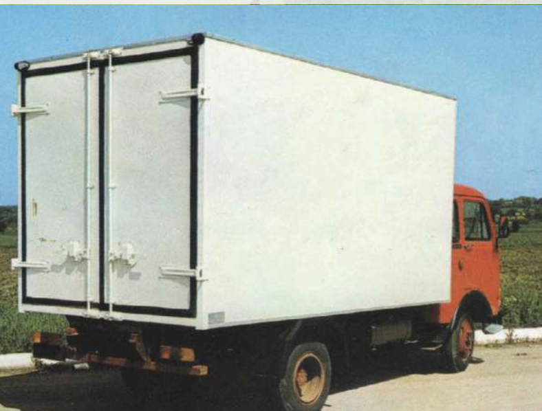
Zaprte furgonske nadgradnje so bile lahko tudi v obliki hladilnikov, narejene so bile iz umetnih materialov, kot je denimo impregnirana plastika.
