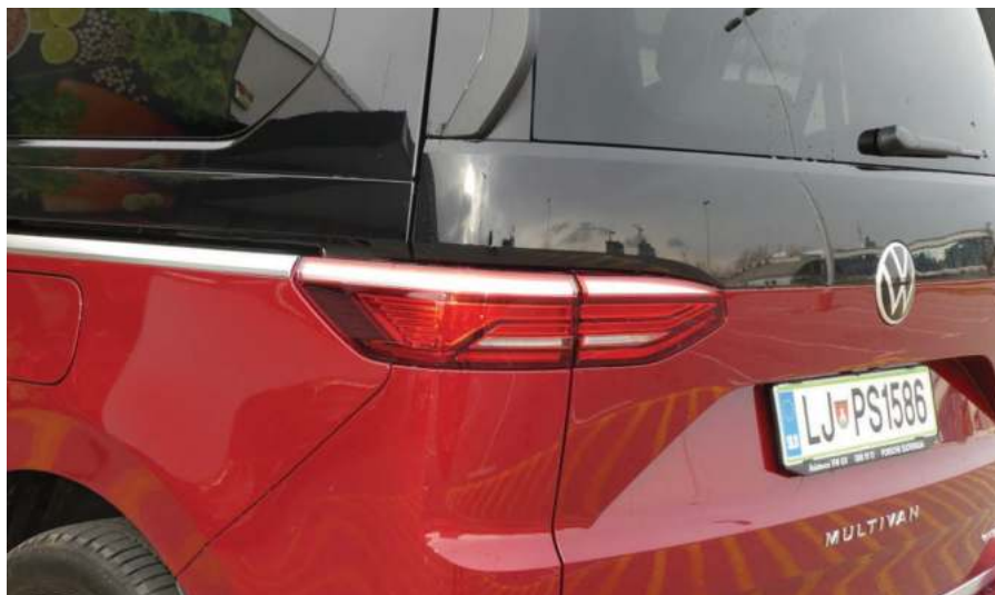
Luči so v full LED tehnologiji. Prvič so na zadku dvodelne luči, pri čemer jih je pol v prtljažnih vratih, pol pa se jih zajeda močno v bok vozila.
