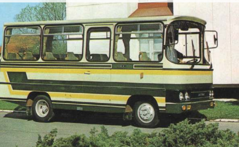
Hercegovina-Auto iz Mostarja je leta 1976 izdelovala minibusse Neretva na podvozjih Zastavinih tovornjakov.
