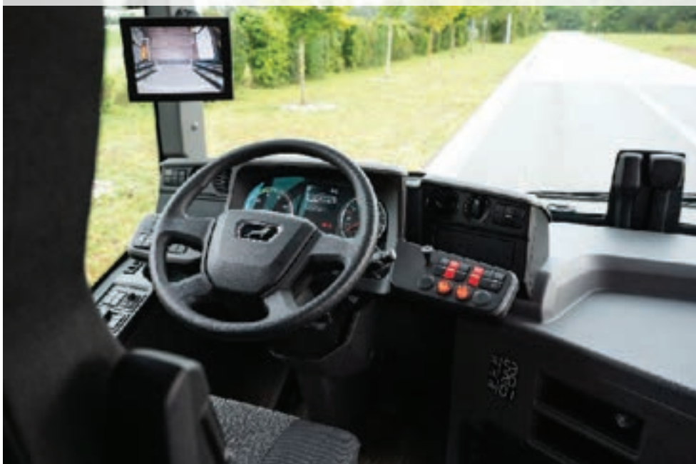
Voznikov delovni prostor je moderno zasnovan, sedež izdatno nastavljen, merilniki pregledni, dodaten monitor pa ponuja sliko dogajanja za vozilom iz kamere z zadnjih vrat.
