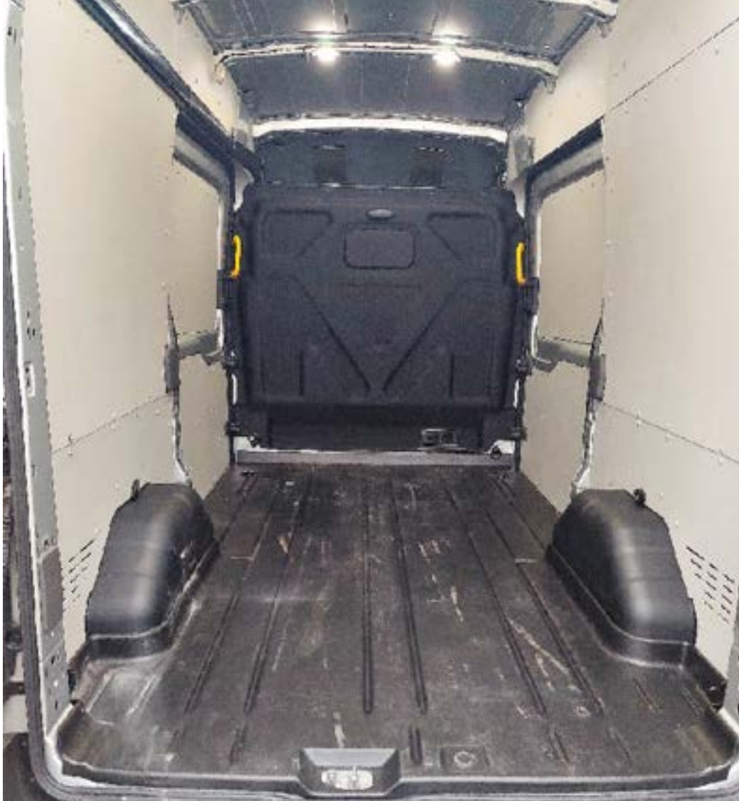
Tovorni prostor je lepo obdelan in zaščiteno pred poškodbami, na tleh je nedrseča podlaga, celoten del pa je osvetljen z LED lučmi.
