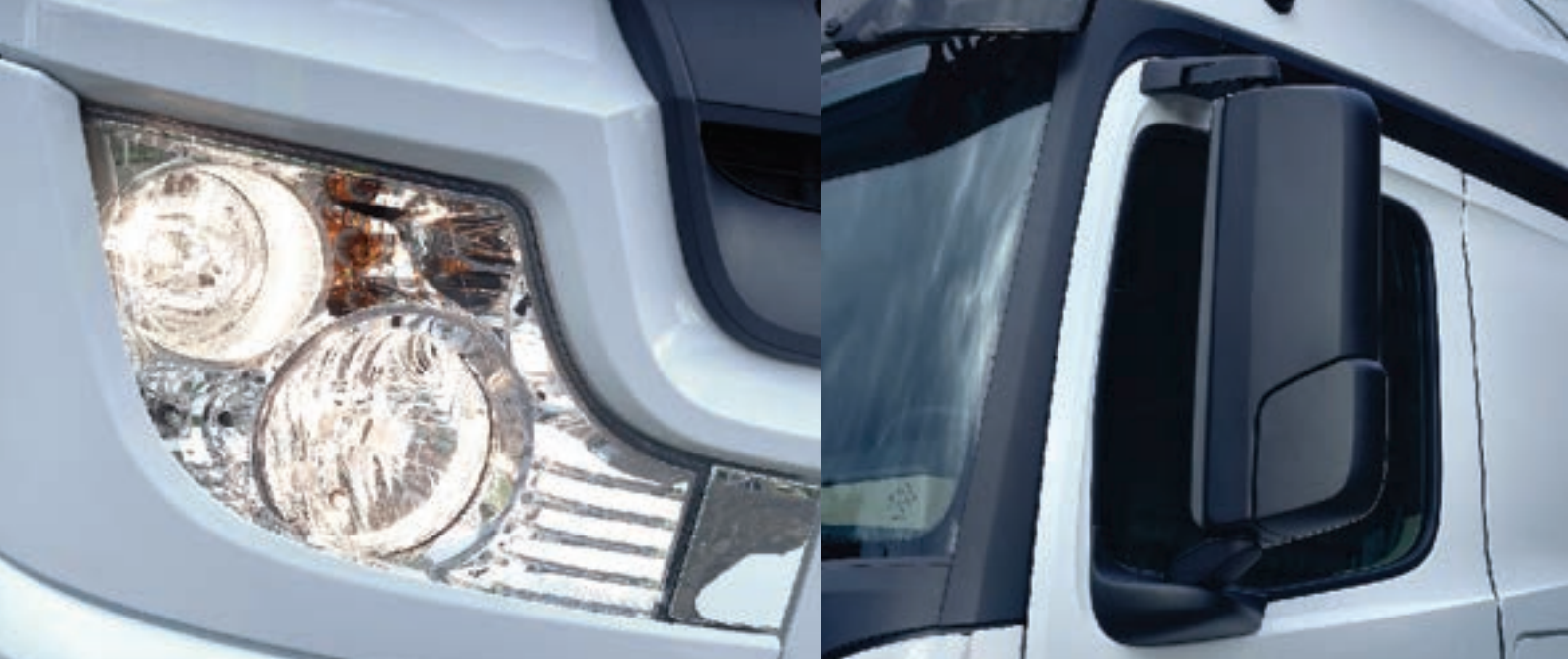
Na Actros F so vedno nameščena le klasična ogledala s črnim ohišjem, luči so klasične, v njih pa manjkajo LED dnevne svetilke.
