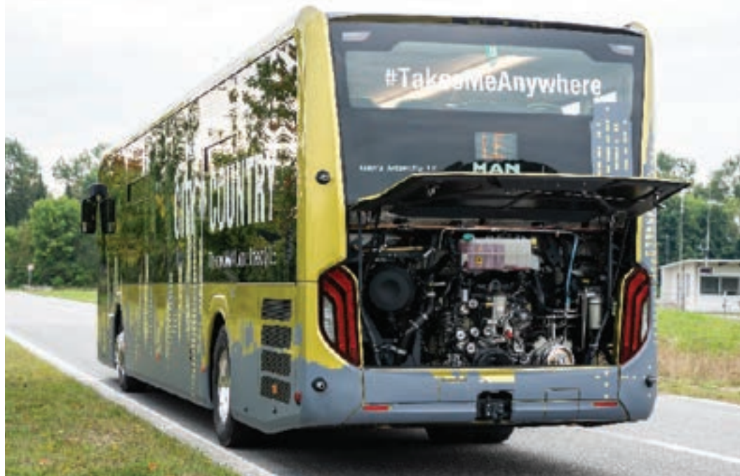
Za vzorno učinkovitost deluje močan D15 s tlaki vbrizga goriva do 2500 barov.
