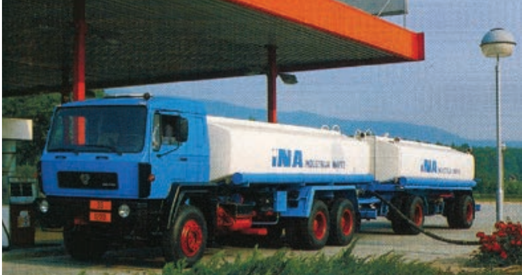
Zaradi majhne kabine in omejene motorne moči je bil TAM 260 T 22/26 bolj uporaben na krajših razdaljah.
