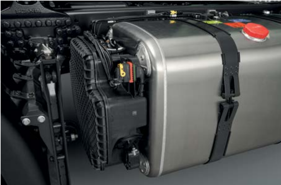
Na pročelje posode za gorivo je vgrajen t.i. FOU sklop, v katerem so filter za gorivo, separator vode in dve nizkotlačni črpalki.
