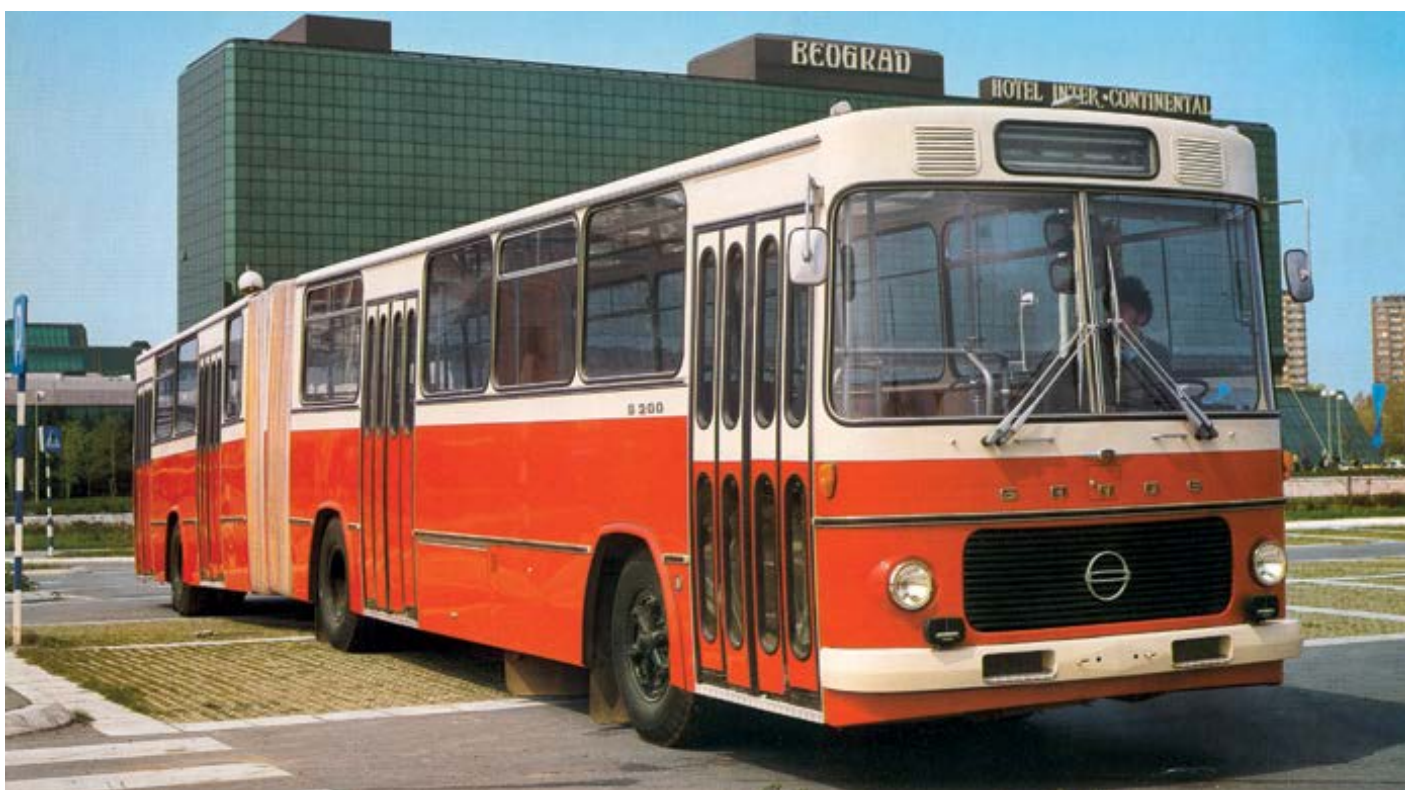
FAP Sanos S-200 – največje dovoljene dimenzije karoserije so omogočale izredno veliko potniško kapaciteto, vendar je brez upravljive tretje osi okretnost močno zaostajala za domačo konkurenco.
