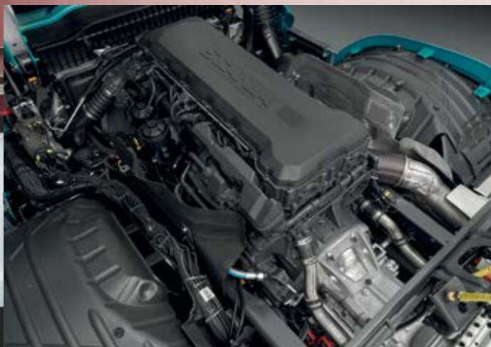
Nov pogled na motor razkriva eno delno glavo, ki omogoča boljši pretok hladilne tekočine, ob dveh odmičnih gredih pa tudi kakovostnejšo izmenjavo zraka v valjih in integrirani CFB motorni zavori.
