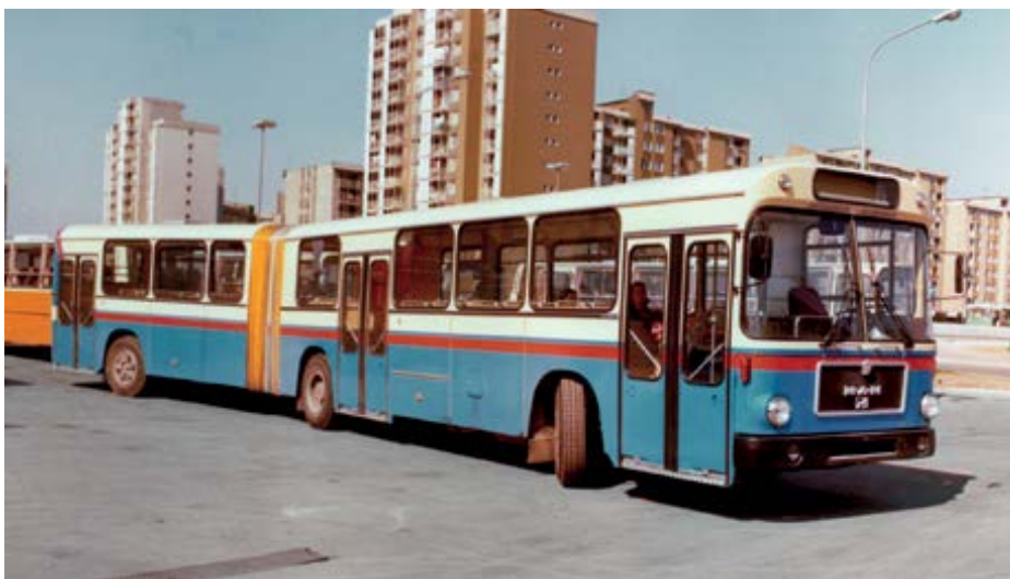
MAN SG 240 – kombinacija MAN-ove šasije in Avtomontažine karoserije po zgledu nemških modelov VÖV se je izkazala za najboljšo v segmentu mestnih avtobusov na našem področju.
