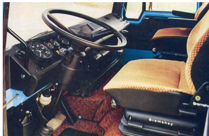
Plastična armatura z merilno ploščo pred voznikom in vzmeten sedež.
