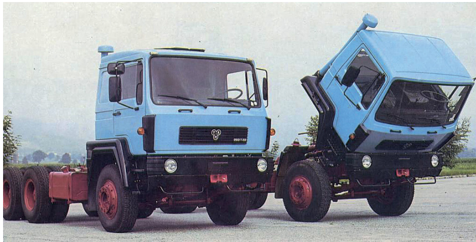
TAM 260 T 22 B – z novim motorjem V-8 se je TAMu leta 1983 znatno zmanjšal zaostanek za tovornjaki in avtobusi iz Priboja, najmočnejši model je imel tri osi in pogon 6x4 ali 6x6. Za težja tovorna vozila (190–260) je bila na voljo podaljšana kabina BL za spanje.
