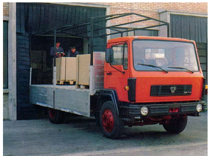
TAM 130 T 11 B – nova oznaka od leta 1983 je nakazovala povečano nosilnost, v ponudbo pa je bil dodan kompaktni medosni razmak 2,9 metrov.
