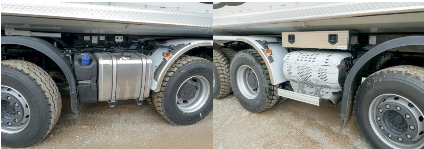
Na okvir med srednjima osema sta na eni strani pritrjeni posodi za gorivo in AdBlue, na drugi pa katalizator in škatla z orodjem.
