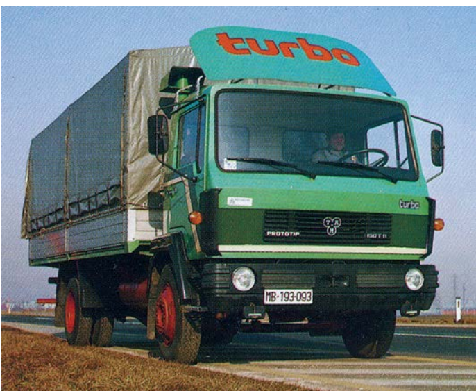
TAM 150 T 11 B – v Mariboru so eksperimentirali tudi s turbomotorji, a je ta model, ki bi zapolnil praznino med 4- in 6-valjnimi motorji, ostal v fazi prototipa.
