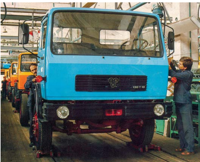
TAM 130 T 10 B je bil uveden v proizvodnjo konec leta 1981 v treh medosnih razdaljah: 3,2, 3,8 in 4,2 m.
