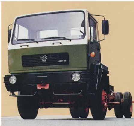
TAM 190 T 15 B – od leta 1983 so bile na voljo težje izvedenke z zadnjo generacijo V6 motorjev, kakršni so se že nekaj časa vgrajevali v avtobuse, za prenos moči pa je bil uporabljen FAMOS menjalnik.
