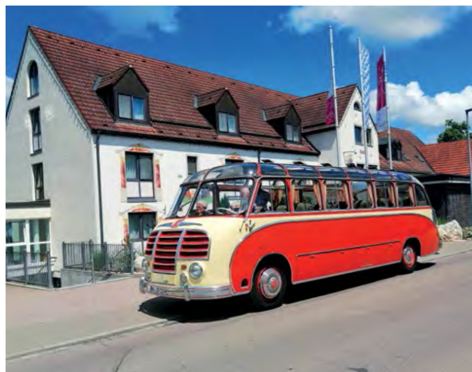
Prvi avtobus z oznako S8, z osmimi vrstami sedežev, s samonosno karoserijo, zadaj postavljenim motorjem in neposrednim prenosom na zadnja kolesa.
