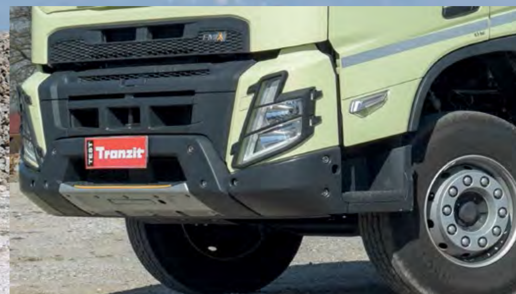
Robustnost poudarja zaščita podvozja, močnejši odbijač in žarometi s trpežno zaščitno mrežo.
