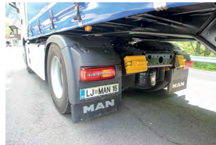
Da so lahko na obeh straneh šasije posodi za gorivo in katalizator, je večina ostalih elementov – posoda za zrak, akumulator, zagozde – za pogonsko osjo.
