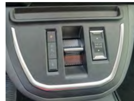
Posebno stikalo za vklop pogona naprej in nazaj ter stikalo za izbiro načina vožnje Eco, Normal ali Power.
