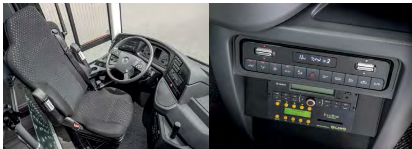
Voznikov delovni prostor je povsem prenovljen, merilniki so znani, saj so prevzeti iz Actrosa, vsa stikala so na dosegu roke, tako da voznik med vožnjo nima težav z iskanjem in nastavljanjem recimo temperature.
