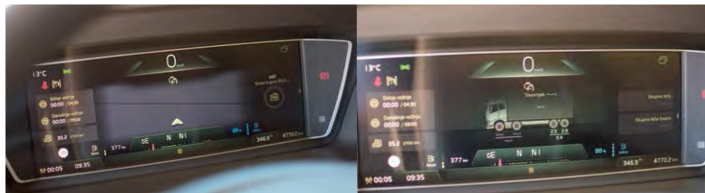
Nova, sodobna, digitalna plošča z merilniki ponuja 4 različne poglede, ki jih izbira uporabnik sam glede na to, katere podatke pri uporabi potrebuje.
