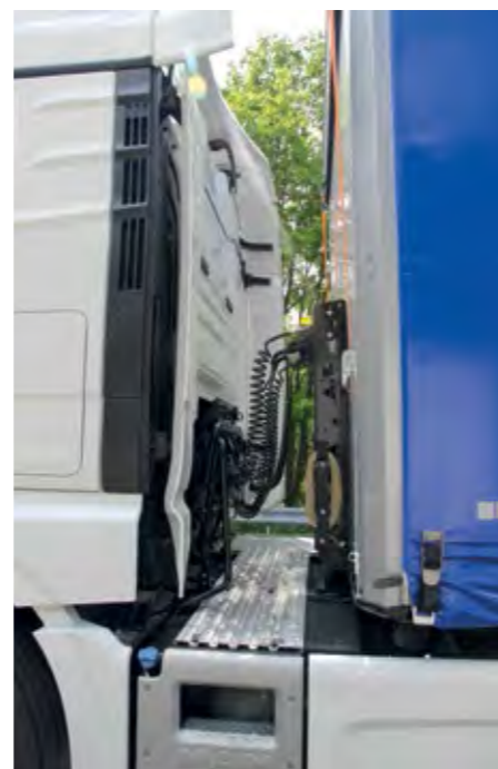
Oba bočna spojlerja se zdaj elegantno preklopita za kabino, kar omogoča lažji dostop do priklonih cevi.
