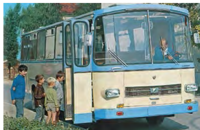
TAM AS 3500 D – novi model z začetka 70-ih let je postavil temelj bodočih potniških modelov na klasični TAM-ovi šasiji z motorjem V6 in listnatimi vzmetmi.
