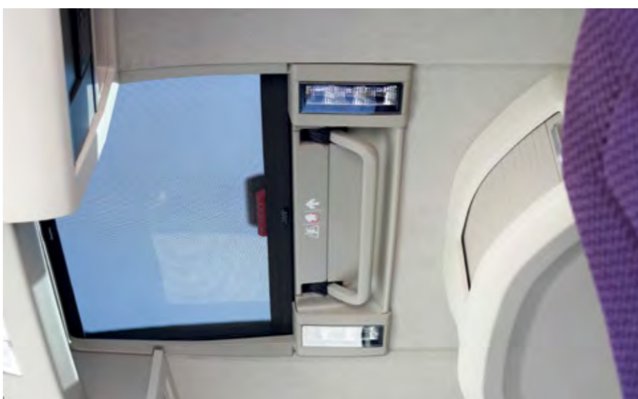
Strešno okno služi tudi kot zasilni izhod.
