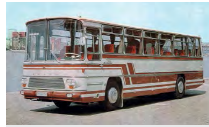
FAP Sanos S 12 – stalni napredek je vključeval številne karoserijske detajle ter zračno vzmetenje in Famos motor 2F, kateremu sta bili povečani delovna prostornina ter moč na 190 KM.
