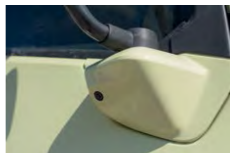
V ohišju desnega ogledala je kamera, ki spremlja dogajanja v mrtvem kotu.
