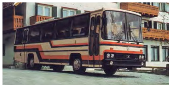
TAM 190 A 11 T – leta 1981 so vgradili motor s povečano močjo, istočasno pa so prenovljeni vetrobransko in bočna okna.
