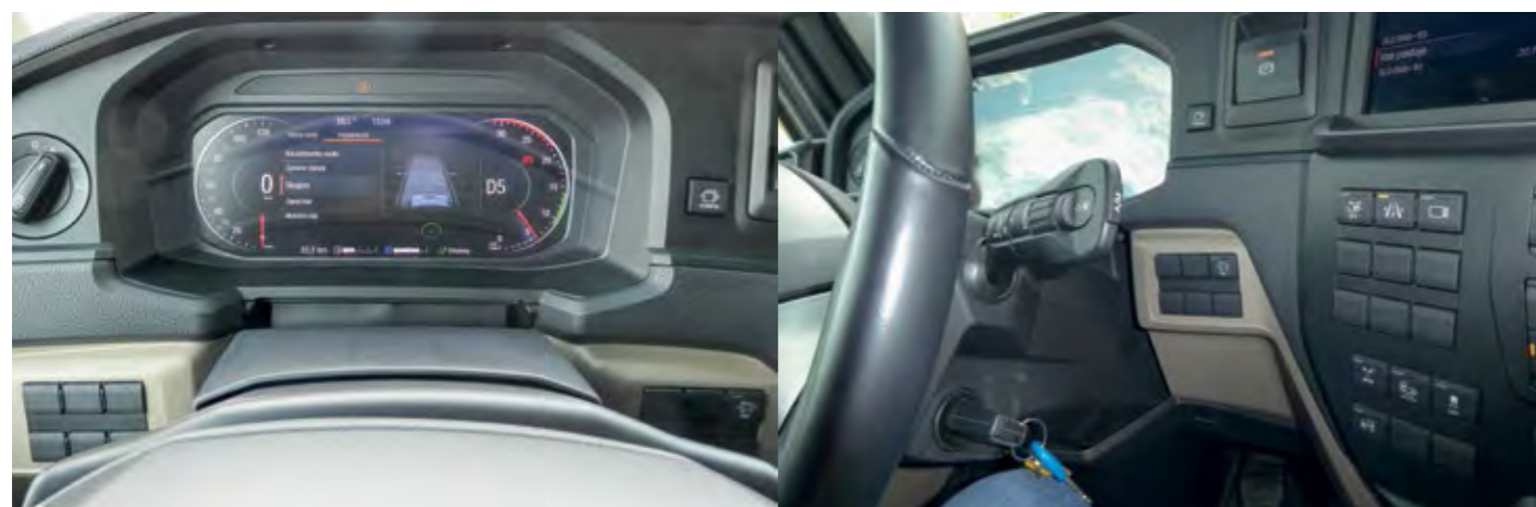
Meni in vsi napisi v plošči z merilniki so v slovenskem jeziku. Velika novost je izpustitev krožnega stikala za vklop menjalnika, katerega sedaj vklapljam prek desne obvolanske ročice. Prav tako je novost stikalo za vklop elektronske parkirne zavore, ki se samodejno aktivira, ko ugasemo motor.
