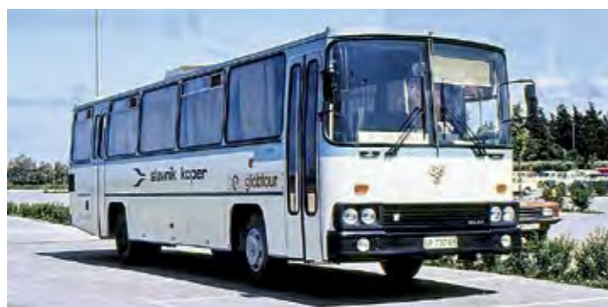
TAM 170 A 11 T/L – v začetku 80-ih let ponovni redizajn in podaljšan zadek, pri tem se je ustalila še ena sedežna vrsta.
