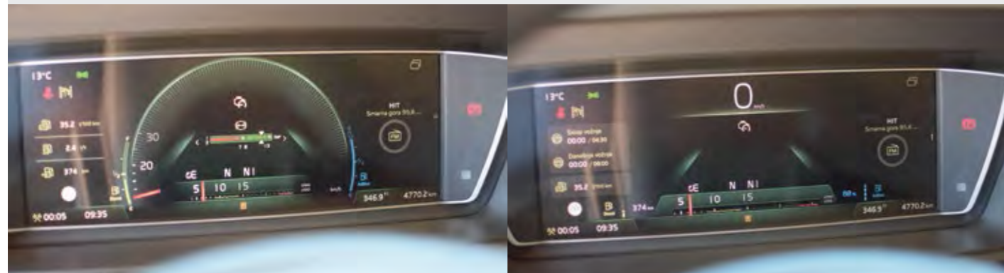
Nova, sodobna, digitalna plošča z merilniki ponuja 4 različne poglede, ki jih izbira uporabnik sam glede na to, katere podatke pri uporabi potrebuje.
