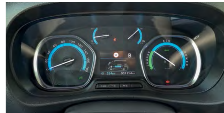
Plošča z merilniki je prilagojena električnemu pogonu in prikazuje delovanje elektromotorja, napolnjenost baterije, doseg in hitrost.
