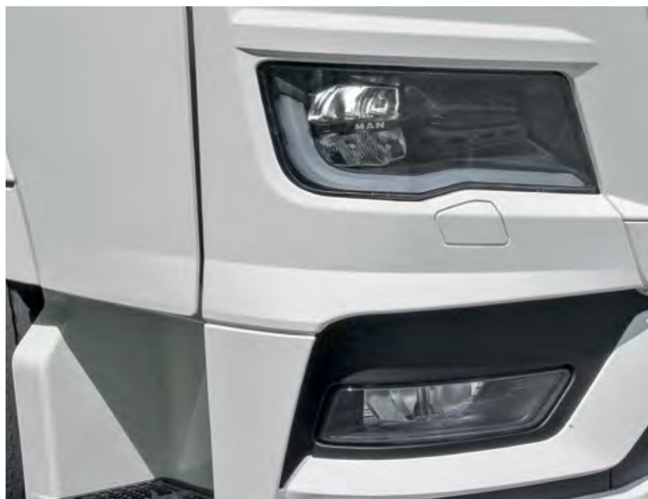
Odbijač pade skoraj do tal ter skupaj z meglenkami tvori optično celoto. Nekoliko višje je glavni žaromet, ki je sestavljen iz več svetilnih segmentov.
