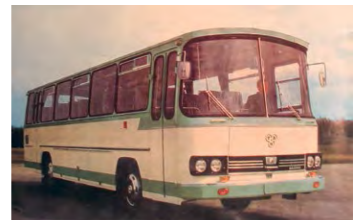
TAM AS 3500 E – redizajnirano Avtomontažino karoserijo sta obeleževali nova moderna maska in dolžina vozila, ki je zrasla na 10,64 metra.
