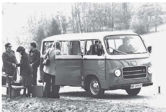
V model IMV 1600 BR se je leta 1976 začel vgrajevati Renaultov motor iz modela Renault 16. Redizajnirano karoserijo prepoznamo po novih lučeh in večjem vetrobranskim steklom.
