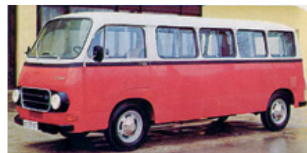
IMV 2200 D v potniški izvedbi je imel karoserijo dolgo 5,3 m in je bil težak 1,7 tone. V njem je bilo prostora za 9 do 12 potniških sedežev.
