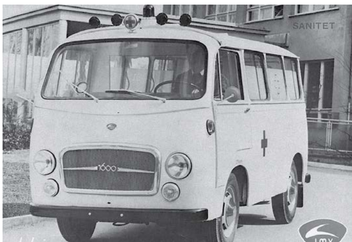
IMV 1600 B – dvotaktni DKW trivaljni motor s prostornino 981 ccm in 38 KM je leta 1967 nadomestil štiritaljni štirivaljni BMC (1662 ccm, 62 KM) in nov 4-stopenjski sinhroniziran ZF menjalnik.
