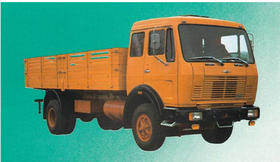
Na podvozje »Trafike« so namestili novo Mercedesovo kabino, s čimer je nastal poceni koktajl, ki je vizualno deloval zelo moderno.
