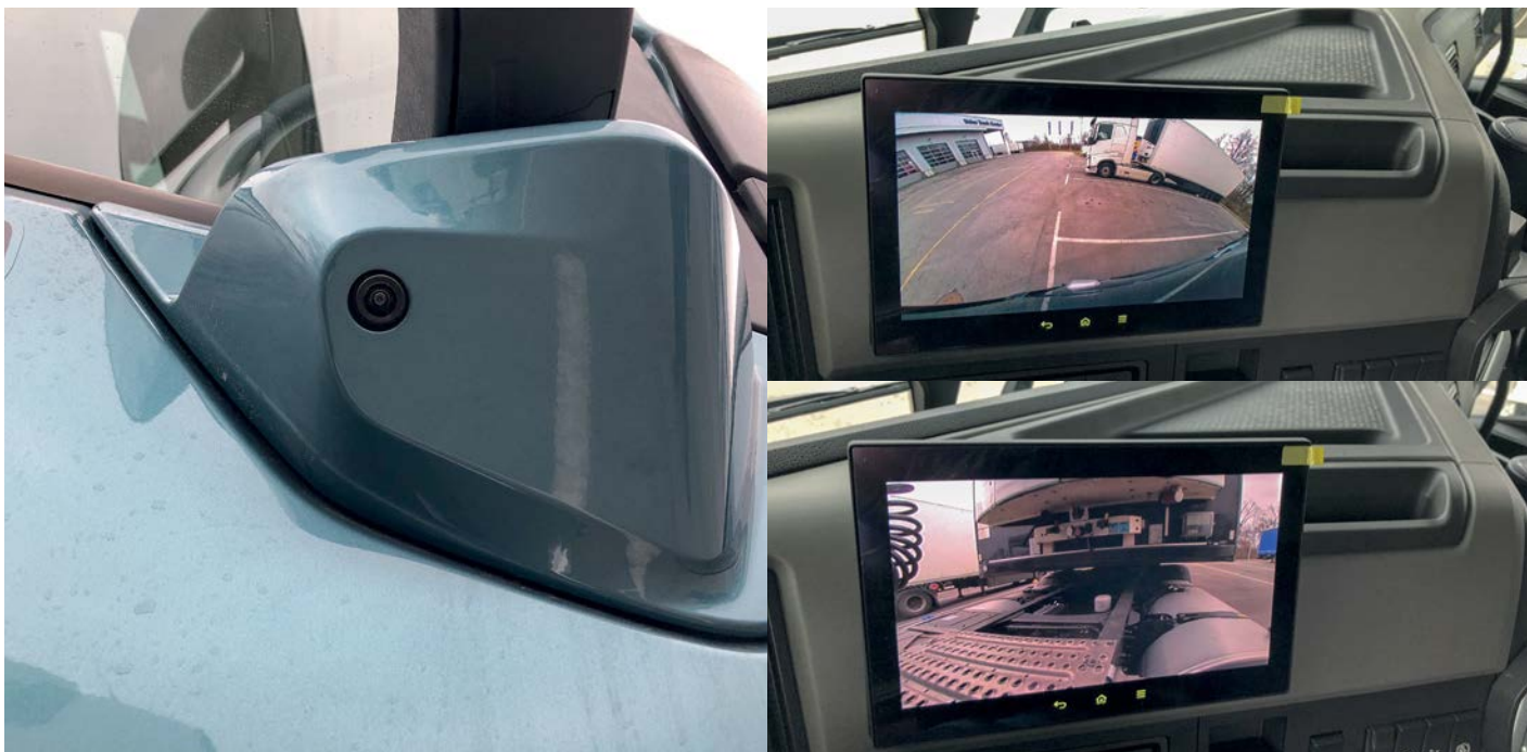
V nosilcu desnega vzvratnega ogledala je kamera, ki pokriva mrtvi kot in sliko prikaže na sredinskem zaslonu. Prav tako dodatna kamera pokriva zadnji del vozila in olajša priklop polprikolice.
