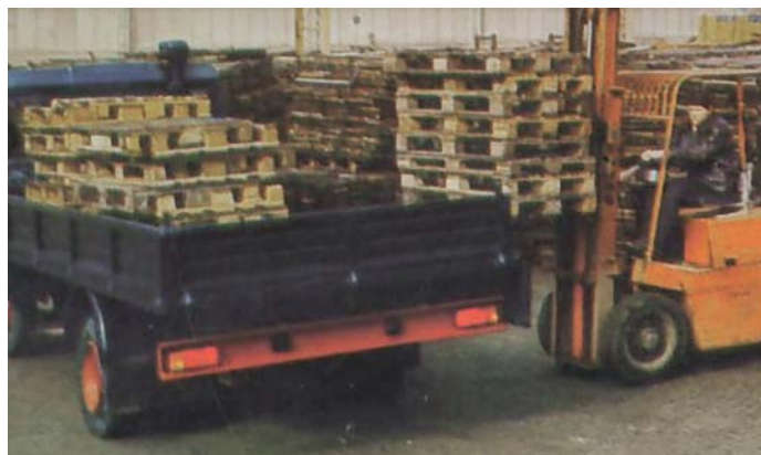
Zastava 640/645 – prenovljen model je eden prvih tovornjakov z uspešno oblikovanim zadnjim odbijačem proti podletu.
