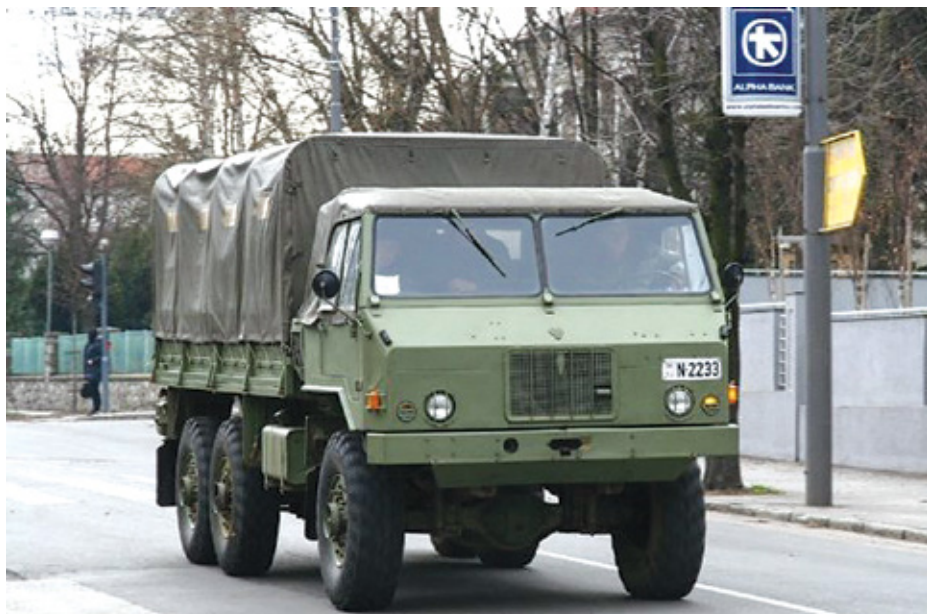
TAM 150 T 11 BV 6x6, po modularnem pristopu je na enaki osnovi nastal prvi TAMov triosovinec z nosilnostjo 5 t na cesti in 3 t na terenu. Vgrajeval se je V6 motor F 6 L 413 F, ki je v kasnejši fazi razvoja dosegel že 9572 ccm, 150 KM in 490 Nm.
