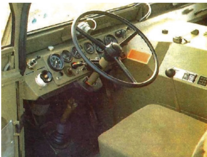
Preprost in tesen kokpit z visokim motornim tunelom in s kar petimi ročicami, prek katerih se je prestavljal menjalnik, pogon med dvema in štirimi kolesi, reduktor menjalnika, vitel in dodatni PTO odgon.
