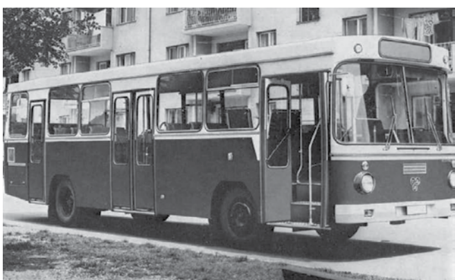
TAM AS 3500 EM – Autokaroserija Novi Sad je leta 1971 razvila funkcionalno karoserijo mestnega avtobusa, pri kateri pa je bil viden vpliv nemških modelov pod standardi VÖV. TAMova šasija na listnatih vzmeteh in »šibka« pogonska skupina pa sta omejevali njegovo uporabnost.
