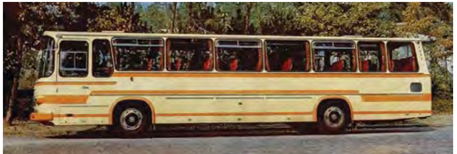
Magirus-Deutz RT 120 – dopolnilni program z originalnim modelom partnerskega KHD žal ni nikoli v popolnosti zaživel. Najbolj uspešna kombinacija je bila Avtomontažina karoserija v videzu kot pri TAMu in šasija Magirus-Deutza z zračnim vzmetenjem in motorjem z močjo 232 KM.
