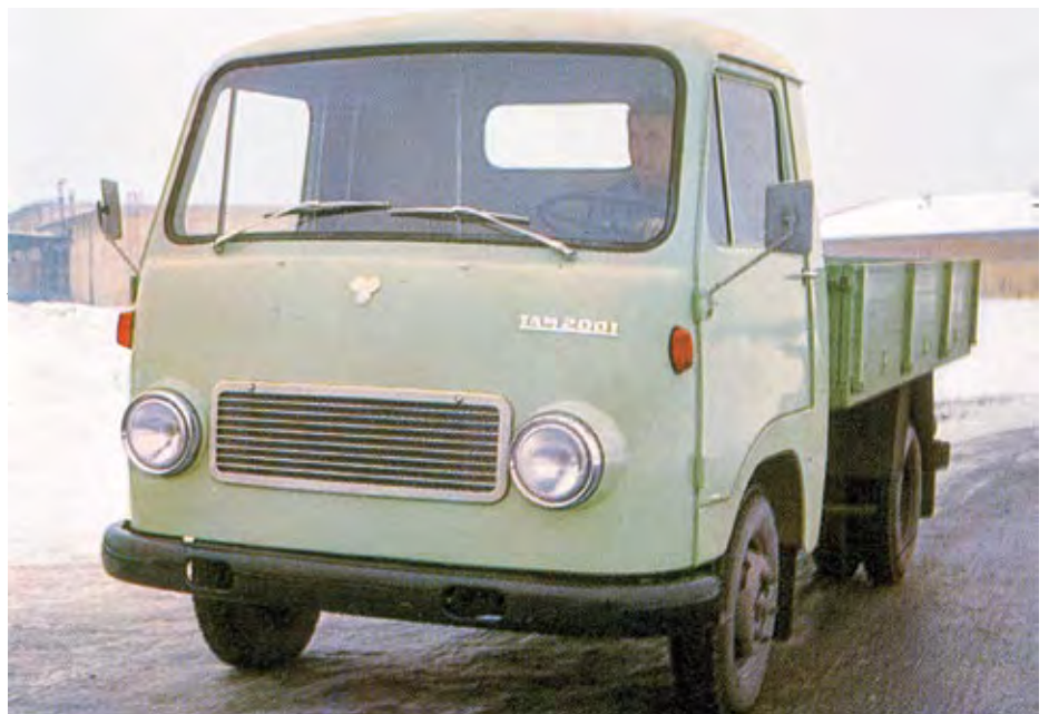
TAM 2001 – pri redizajniranem Tamiču pod novo oznako je od leta 1970 opazna nova štirioglasta maska hladilnika in enodelno vetrobransko steklo. Vgrajen je nov motor IMR M 34/V z močjo 61 KM in 5-stopenjskim menjalnikom z ročico na podu. Nova je bila plošča z merilniki, postavljena pred volanski obroč, po želji stranke pa so lahko na povišani motorni tunel vgradili tudi tretji sedež.
