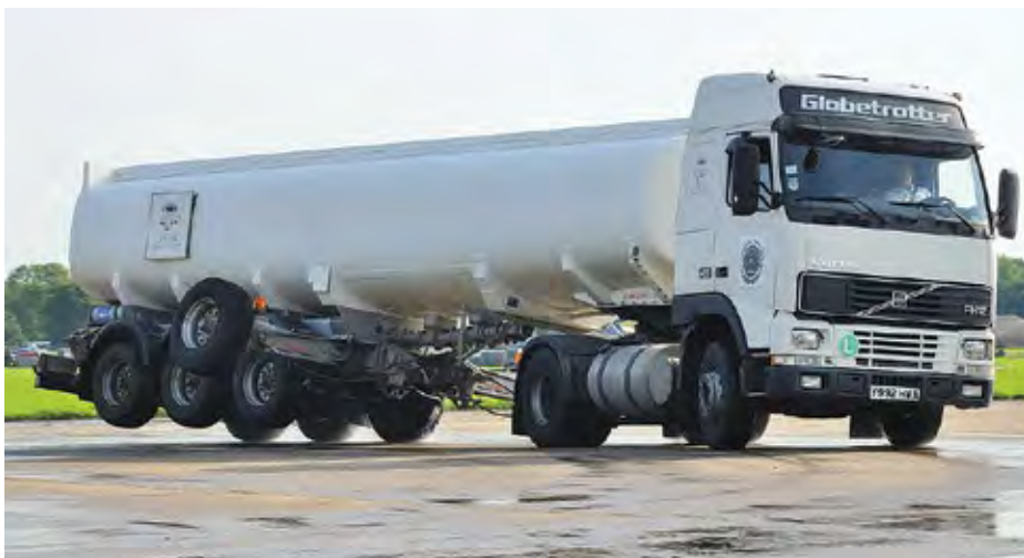
ESC deluje tudi na priklopnih vozilih.
