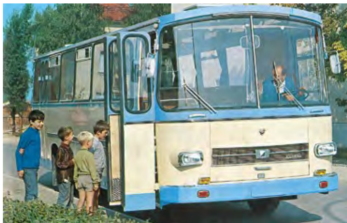
TAM AS 3500 D – po različnih izvedbah modelov avtobusa Vesna in Janez je novi model iz ljubljanske Avtomontaže postavil temelj prihodnjih TAMovih avtobusov. Konkurenčnost mu je leta 1971 močno povečal novi 6-valjni motor, ki je iz novih 8422 ccm, prej 7983, razvijal 150 KM, prej 125 KM.
