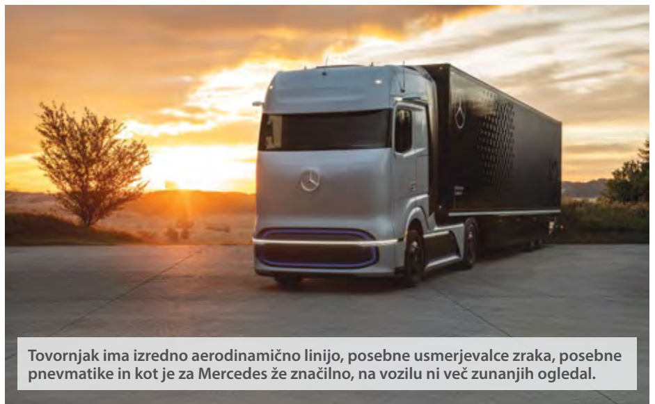
Zvezda nove strategije za segment prevoza na dolge razdalje pa je zagotovo tovornjak z gorivnimi celicami s pogonom na vodik.
