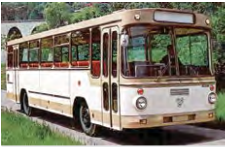
TAM AS 3500 EM – karoserija z dolžino 10,66 m je bila na voljo tudi za primestne izvedbe z dvojnimi vrati, 47 sedeži in prtljažnim prostorom pod podom.
