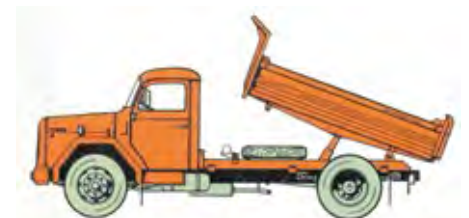
TAM 125 T 12 K – v Dojca so od leta 1977 vgrajevali tudi starejšo izvedbo 6-valjnega motorja F6 L 614, ki je bil s 125 KM le malenkost močnejši od štirivaljne izvedbe in težji za 120 kg. Zaradi tega je bil redka izbira prevoznikov. Uporabljali so ga za gradbena dela s prekucno nadgradnjo, saj je imel za dve toni večjo nosilnost.
