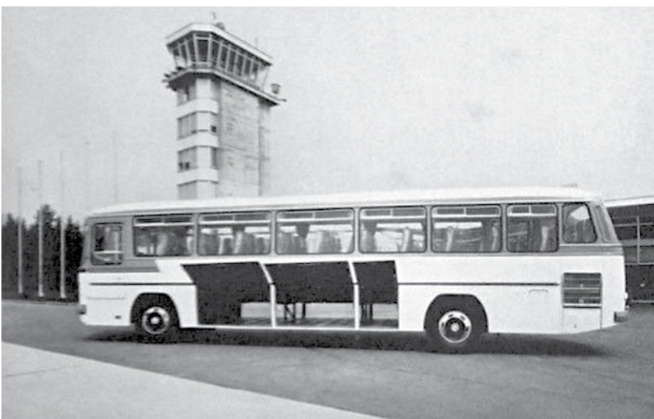
Mercedes-Benz O-302 iz ljubljanske Avtomontaže je prepoznaven po posebnih pokrovih koles in dvignjenem zadnjem steklu.
