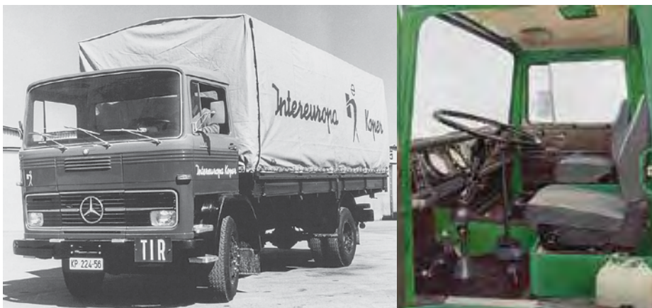
Mercedes-Benz LP 1113 je bil prvi tovornjak iz »domače« proizvodnje z moderno nagibno trambus kabino in motorjem z neposrednim vbrizgom, ki je lahko razvijal 1230 KM.
