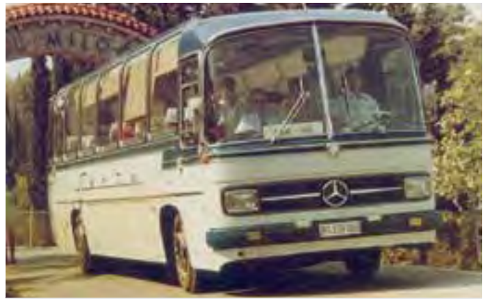
Izvedba skopskega 11. Oktomvri je bila prepoznavna po nižji liniji bočnih stekel ter drugačni obliki strehe, dolžina avtobusa je bila 12 metrov.
