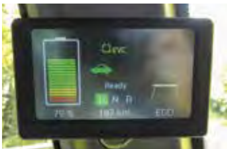
Poseben ekran na levem A stebričku nam nazorno pokaže, koliko energije je še v baterijah, pa tudi kakšna je rekuperacijska moč.
