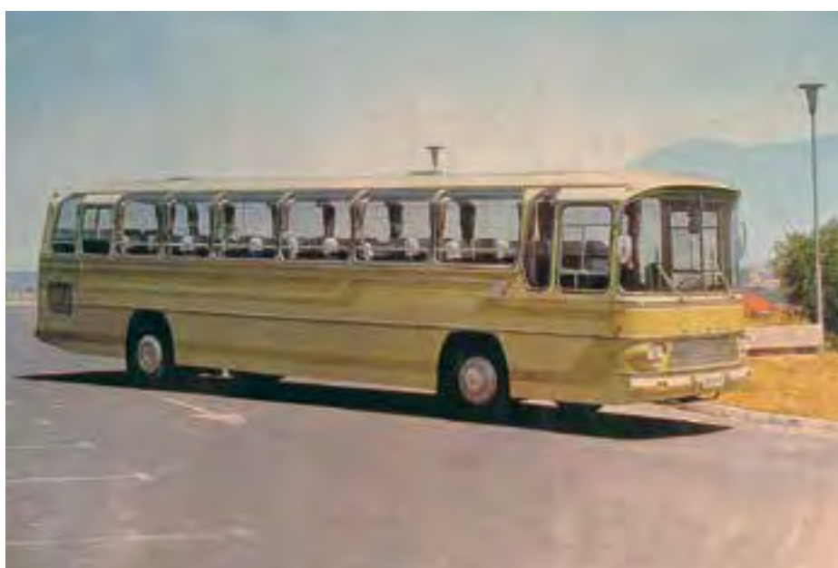
FAP-Sanos S 12 De Luxe – luksuzna izvedba z zakrivljenimi stekli. Po vzoru Mercedes in z uporabo njihovih tehničnih rešitev je bil ta Sanos prvi domači avtobus z zračnim vzmetenjem.
