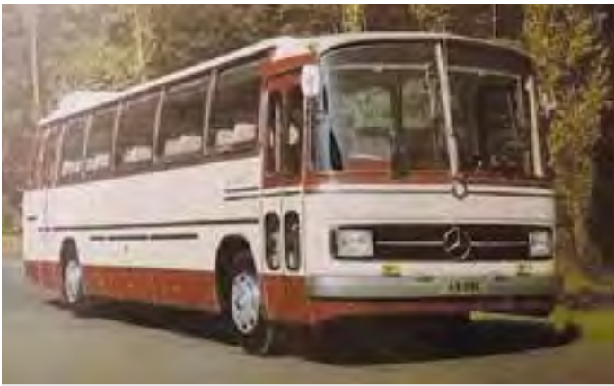
Mercedes-Benz O-302, narejen v zagrebški Automontaži: dolžine 10,95 metra s klimo na strehi, zračnim vzmetenjem in 8,72-litrski motor OM 360 z močjo 170 KM.
