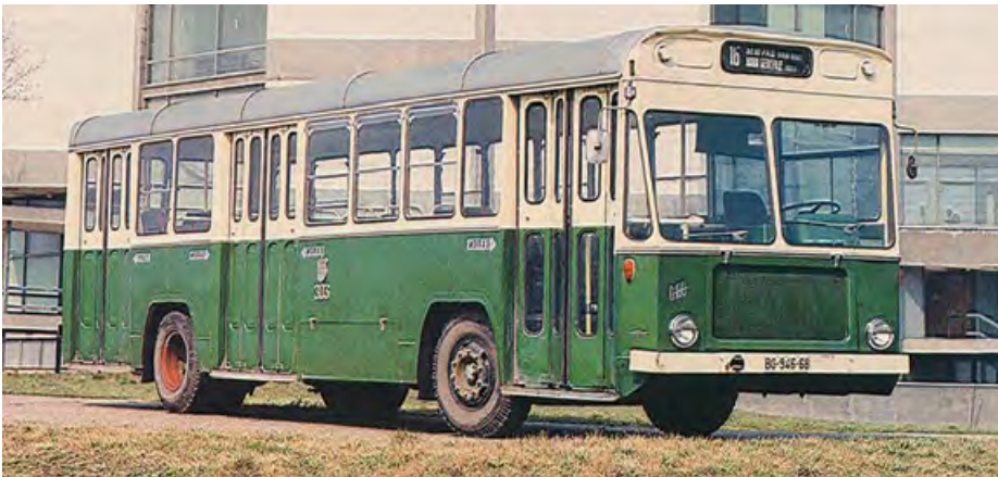
Ikarus G-100 na šasiji mestnega avtobusa je ostal v prototipni fazi. Proizvajalec je predvideval vgradnjo različnih motorjev, pa tudi karoserija je bila modularna in jo je bilo lahko namestiti na različna podvozja.
