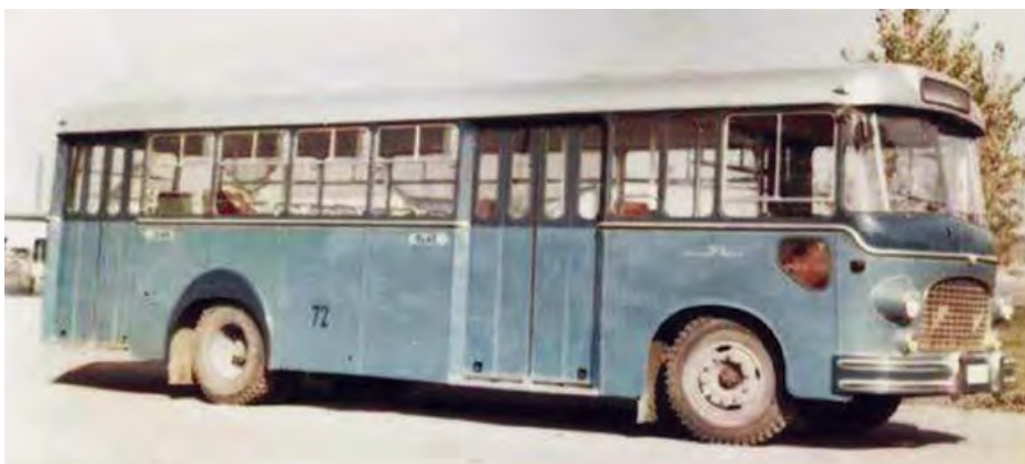
Mestni avtobusi v Jugoslaviji so bili v šestdesetih letih pretežno narejeni na kamionskih šasijah različnih proizvajalcev, med katerimi je prednjačil FAP. Kapaciteta teh vozil je bila premajhna, položaj vhodnih vrat pa je onemogočal, da bi karte za prevoz prodajal voznik.
