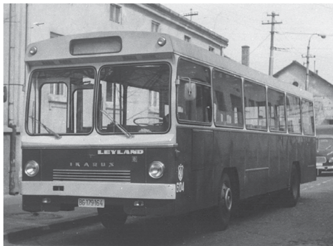
Modularna karoserija, prilagojena različnim podvozjem, kot sta Leyland ali Volvo.
