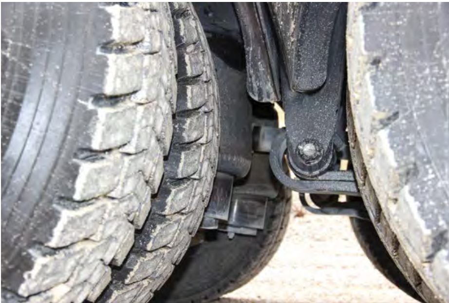
Vpetje zadnjih dveh osi je precej specifično, saj sta vpeti s kombinacijo nihajne roke in zračne blazine.
