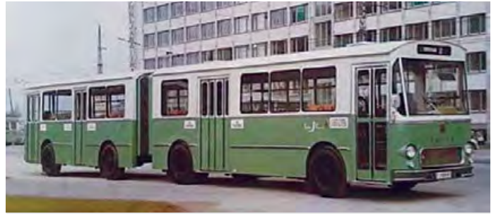
Krapan, prvi zglobni avtobus v Jugoslaviji. To je avtobus s prikolico, ki sta fizično spojena in omogočata prehod potnikov med obema deloma. Nastal je leta 1967 v delavnicah prevozniškega podjetja LT iz Ljubljane na Fiatovem podvozju. Vsega skupaj je bilo narejenih 15 primerkov.
