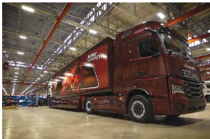
Kamere namesto ogledal, solarni paneli na strehi, poseben hibridni pogonski sklop, ki deluje v sodelovanju s TraXon hibridnim menjalnikom.
