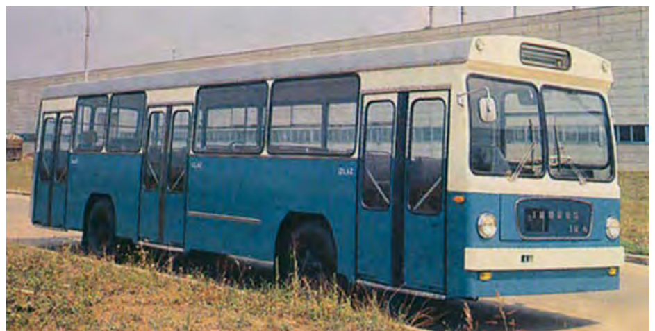
Ikarus IK-4, prvi domači avtobus, ki je lahko zadovoljil potrebe večjih mest. Po izgledu spominja na nemške avtobuse VÖV, ampak manjka zračno vzmetenje in zglobna izvedba.
