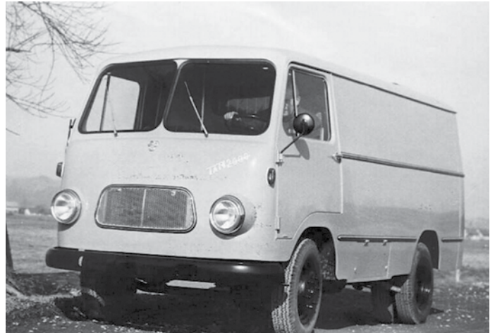
Zaradi novih zakonskih odredb so morali pri Tamiču leta 1968 zamenjati smer odpiranja vrat ter na novo postaviti način odpiranja oken.
