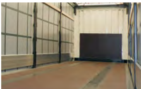
Na zgornji strani je pod ojačan vzdolžno z dvema tirnicama, na spodnji strani pa prečno z dodatnimi nosilci. Z vezano ploščo je ojačana tudi sprednja stena.
