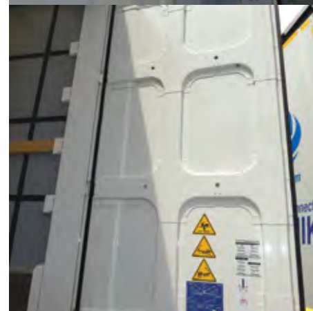
Nova sprednja stena ponuja boljšo ureditev priklopnih stikal, zadnja vrata pa so bolj čvrsta.
