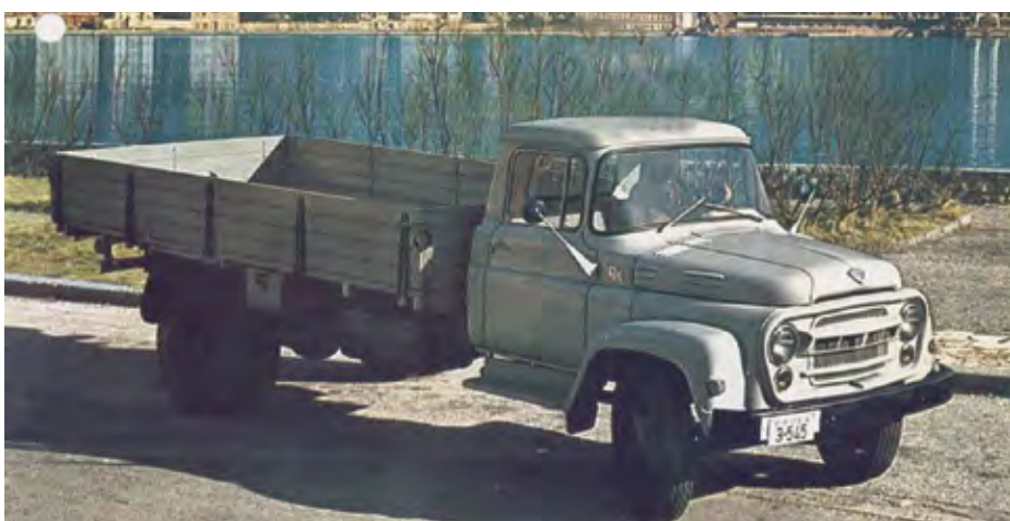
Zaradi kompenzacije dolgov Romunije do Jugoslavije so po politični odločitvi leta 1965 v reškem Torpedu pričeli z montažo lahkega tovornjaka Stegul Rosi SR 113 z nosilnostjo 5 ton. Najvažnejša komponenta, ki jo je dodal Torpedo, je bil dizelski motor z močjo 95 KM. Enak motor so kasneje dobavljali tudi romunskemu proizvajalcu, saj so tam vgrajevali v tovornjak le bencinski motor. Kljub velikim tržnim potrebam pa se je Torpedo SRT slabo prodajal. Leta 1975 so ustavili proizvodnjo, predvsem zaradi zastarelosti in slabe kakovosti. Ob tem je ta model zelo negativno vplival na ugled reške tovarne. Še največji dobitnik v tej zgodbi pa so bili Romuni, saj so na lahek način prišli do dizelskega motorja.
