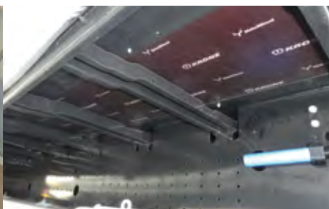
Na zgornji strani je pod ojačan vzdolžno z dvema tirnicama, na spodnji strani pa prečno z dodatnimi nosilci. Z vezano ploščo je ojačana tudi sprednja stena.
