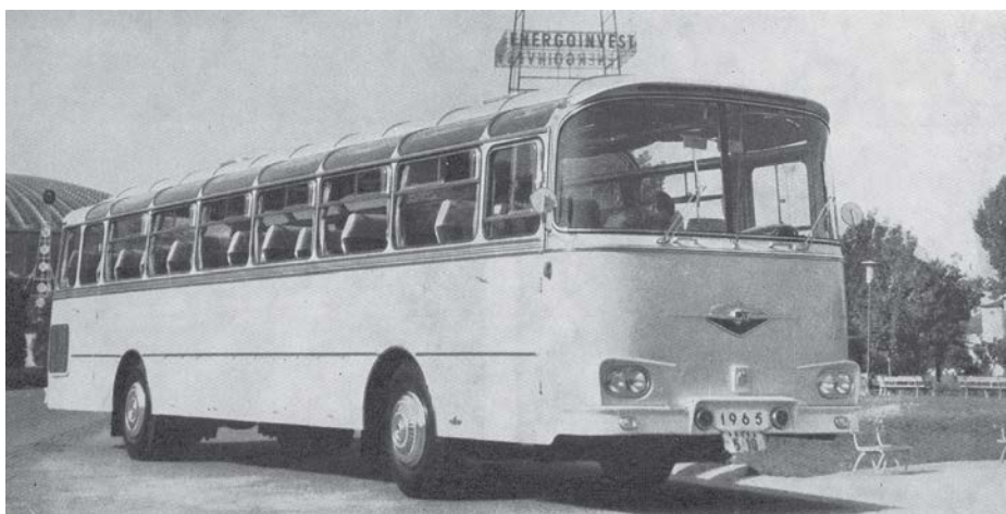
FAP Sanos A-13 – prvi jugoslovanski avtobus z dolžino 12 metrov in lastno težo 8,7 tone. V njem je bilo 51 sedežev. 160-konjski motor, 6-stopenjski menjalnik, na 100 kilometrov pa je porabil 23 litrov goriva.
