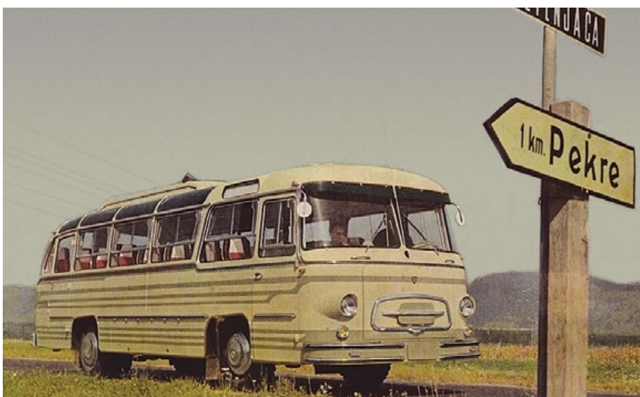
TAM A3500 – prvi TAMov avtobus z moderno samonosilno karoserijo dolžine 9735 mm. Ob lastni masi 7 ton je ponujal 3,8 tone nosilnosti, vanj pa so lahko namestili do 40 sedežev.
