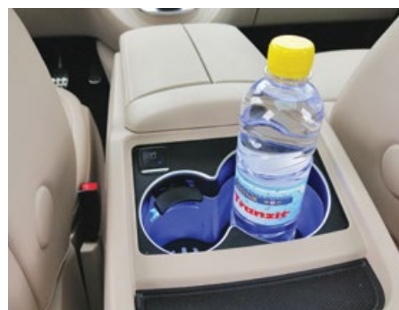
Držalo za dve plastenki pijače omogoča gretje ali hlajenje le-te. Ko je vklopljena modra osvetlitev, se pijača hladi, ob rdeči osvetlitvi se greje.
