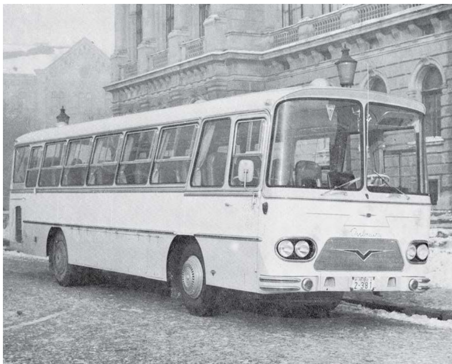
FAP Dubrava 7 – prvi model Autokaroserije Zagreb na novi FAPovi šasiji s karakteristično nagnjenimi nosilci strehe. Dolžina 11 metrov, 43 sedežev, lastna masa 9,2 tone, skupna dovoljena masa 13,02 tone. Motor FAMOS FFB 145 KM.
