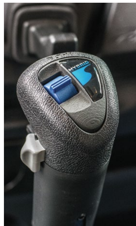
Elektro pogon se aktivira z desnim stikalom na ročici menjalnika.
