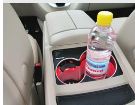
Držalo za dve plastenki pijače omogoča gretje ali hlajenje le-te. Ko je vklopljena modra osvetlitev, se pijača hladi, ob rdeči osvetlitvi se greje.
