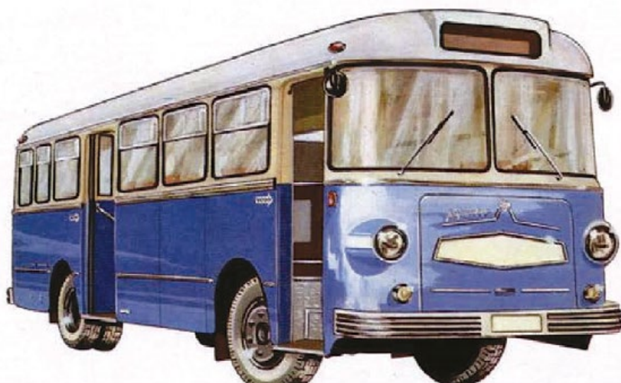
TAM A 3500 M – Samodejna vrata pred prvo osjo pri mestnem modelu omogočajo plačevanje prevoza neposredno vozniku. Ob povečani dolžini na 10,43 metra se je dvignila tudi nosilnost (skupna teža 12,8 t). Predviden je bil za prevoz do 57 potnikov.
