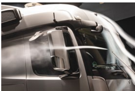
Pri novem Actrosu so dokazali, da odstranitev zunanjih vzvratnih ogledal zniža porabo za 1,5 %.
