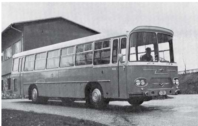
FAP Dubrava 9 – primestni model s samodejnimi vrati. Skupna dovoljena masa je dvignjena na 16 ton, zato je bilo v njem 44 sedežev in 36 stojišč.
