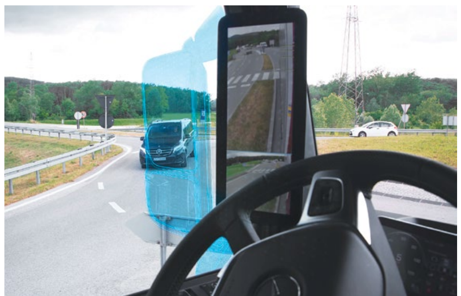
Odstranitev ogledal ima tudi velik varnostni učinek, saj so se zmanjšali mrtvi koti. Kot kaže slika, v primeru uporabe ogledal avtomobila ne bi videli.
