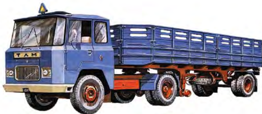
TAM 6500 BVL, prva TAM trambus kabina, nastala v sodelovanju z TŽV Boris Kidrič, je ponujala veliko prostora, ampak je bilo vozilo zaradi omejene nosilnosti in šibkega motorja predvsem uporabno za komunalne naloge.
