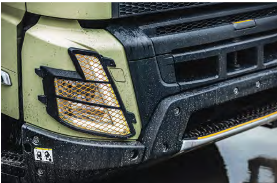
Delovni FMX ima dodatne zaščite luči in motorja.
