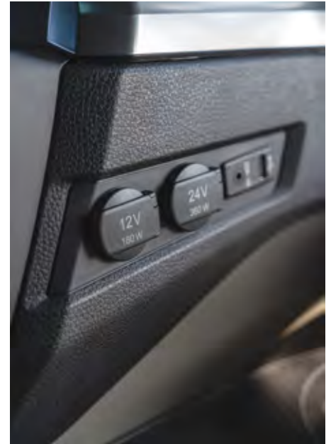
Številni priklopi: 12 V, 24 V, 230 V, USB in AUX.
