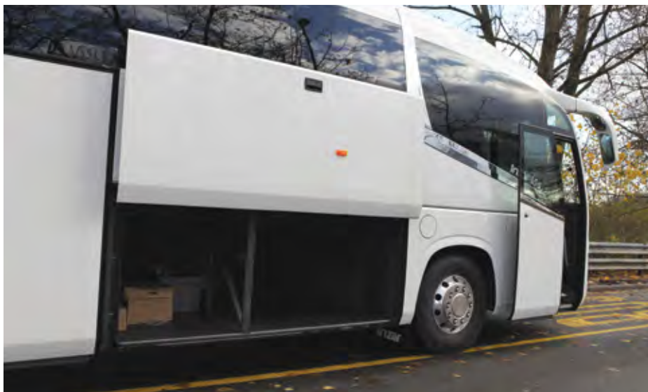
Pri Irizarju se velike lopute prtljažnikov zapirajo pnevmatsko.
