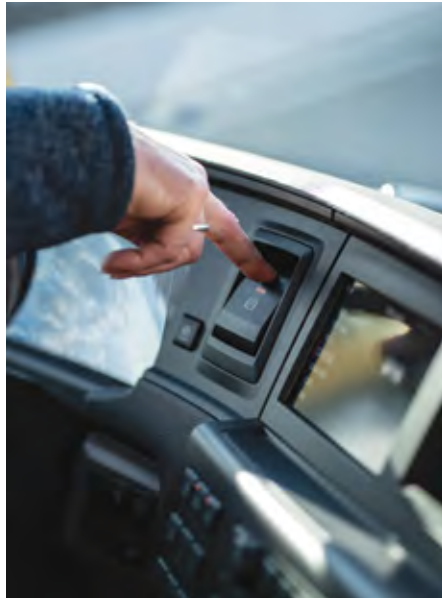
Desno za volanom na armaturi je postavljena nova tipka za električno parkirno zavoro.
