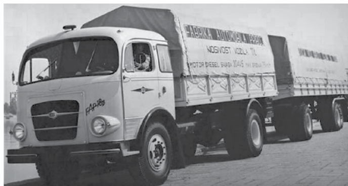
FAP 18 B je bil prvi jugoslovanski tovornjak s spalno trambus kabino in Leylandovim motorjem, ki je razvijal 204 KM, kar je zadostovalo za končno hitrost 75 km/h (po ravnem).
