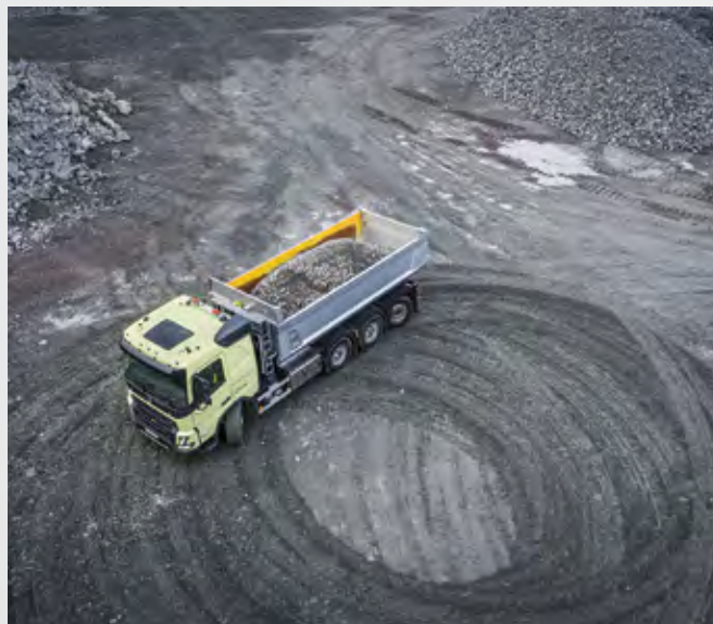
Pri FMXu so krmilni koti povečani, kar zagotavlja boljše manevrske sposobnosti in manjšo obrabo pnevmatik.
