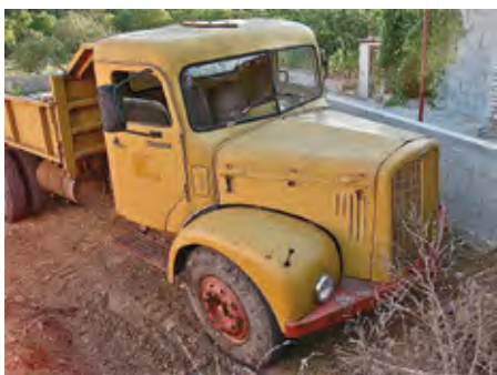
FAP 13, kljub nosu je ostal v srednjem razredu tovornjakov še naprej najbolj priljubljen model. Leta 1962 ga je FAP pod novimi oznakami razglasil za lasten model, čeprav se je minimalno razlikoval od Saurerjevega originala.
