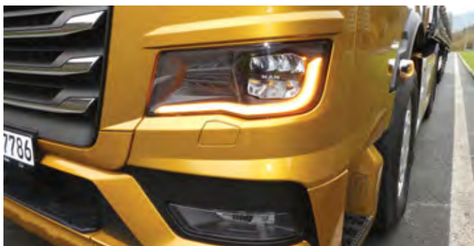
Glavni žaromet je sestavljen iz več svetilnih segmentov, kar omogoča vgradnjo različnih žarnic, tudi povsem novo generacijo LED diod.
