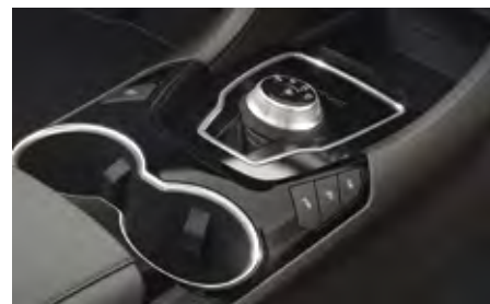
Fordova zanimivost: okroglo stikalo za aktivacijo 8-stopenjskega samodejnega menjalnika.
