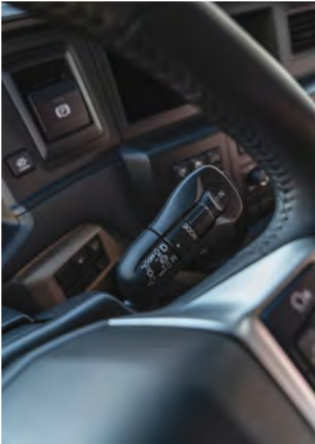
Aktivator menjalnika je sedaj v ročici za volanom na desni strani.
