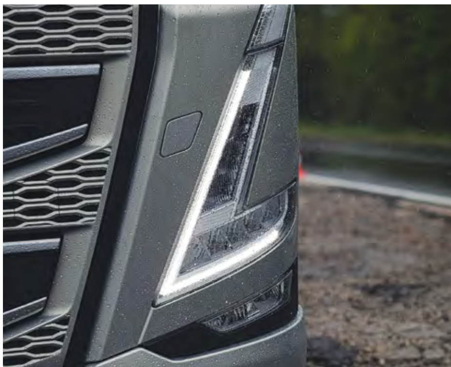
Najbolj opazna novost na kabini so novi žarometi, ki so oblikovani v izrazito črko V in so poravnani z linijo vrat kabine.
