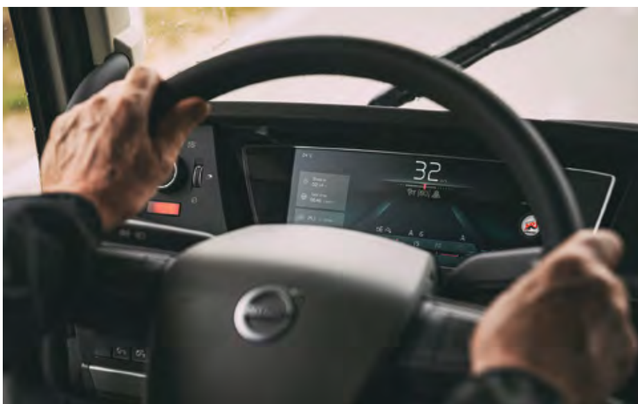
Odvisno od voznih razmer in zelenih prikazanih podatkov lahko na zaslonu instrumentne plošče voznik izbira med štirimi različnimi pogledi.
