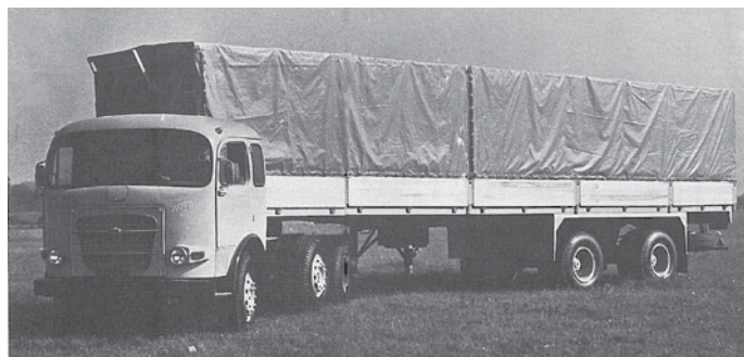
FAP 2222 B, po pričetku sodelovanja z Mercedesom so bile uvedene štirimestne oznake, čemur so v drugi polovici sedemdesetih sledili tudi močnejši motorji 2F 111 B (11 litrov, 220 KM).
