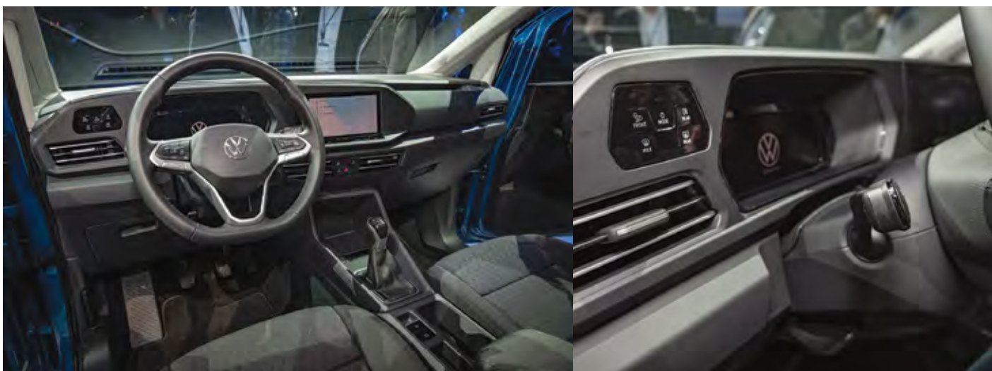
Notranjost je lahko klasična, lahko pa je povsem digitalna. Ni več okroglega stikala za vklop luči, prvič pa je Caddy opremljen z električno parkirno zavoro ter s sistemom za odklepanje vrat in zagon motorja brez uporabe ključa (Kessy).
