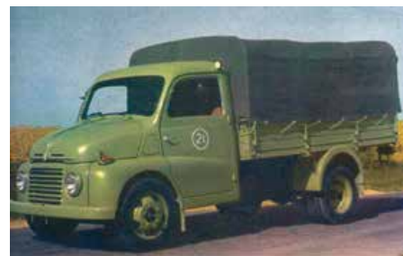
Zastava 620 B. Po začetni proizvodnji modela 615 B v Kragujevcu po Fiatovi licenci so kmalu trgu ponudili tudi model 615 D z dizelskim motorjem. V Zastavi so leta 1961 samostojno razvili za 30 cm podaljšan model, kateremu so nosilnost z 1,5 tone dvignili na 2 tona in ga poimenovali 620 B. B pomeni, da je bil vanj vgrajen bencinski motor, da bi bil avtomobil lažji in da bi omogočal upravljanje z B kategorijo vozniškega dovoljenja. To je bila tudi edina prednost pred »tamičem«, kateremu pa model 620 B s podaljšanim nosom vseeno ni mogel konkurirati.
