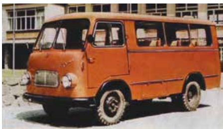
TAM 2000 CB je predstavljal minibus s 13 do 16 sedeži, izvedenka 2000 CF pa furgonsko nadgradnjo.
