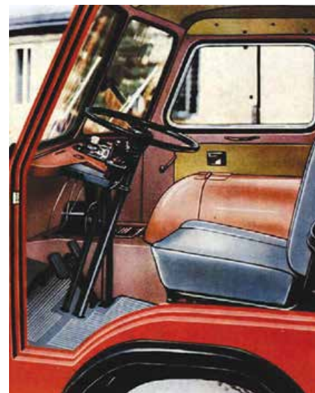
Prvi »tamič« je imel dvodelno vetrobransko steklo in vrata, ki so se odpirala »nazaj«, z drsnimi okni in vzvratnimi ogledali na sprednjem delu kabine. Merilniki so bili postavljeni na sredino armature, ročica menjalnika pa je bila na stebru volanskega obroča.
