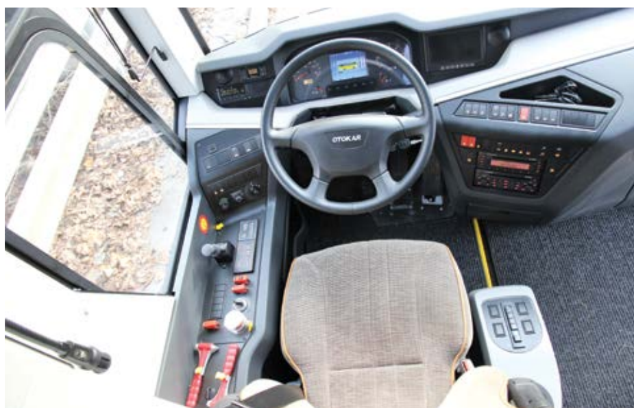
Voznikov delovni prostor je preprost, a ergonomičen. Stikala menjalnika so desno ob sedežu.
