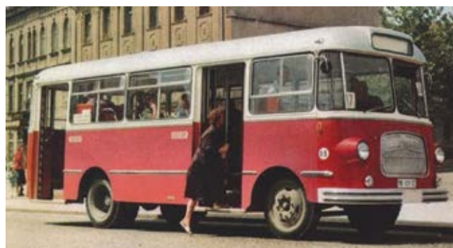
TAM A 3000 M – okrajšava za »mestni«. Na tovarnjaškem podvozju Dojca, nudi 11 sedežev in 50 stojišč na dolžini 8 metrov.
