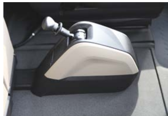
Ob sedežu je ostala ročica parkirne zavore, medtem ko je krožno stikalo menjalnika že nekaj časa na armaturni plošči.
