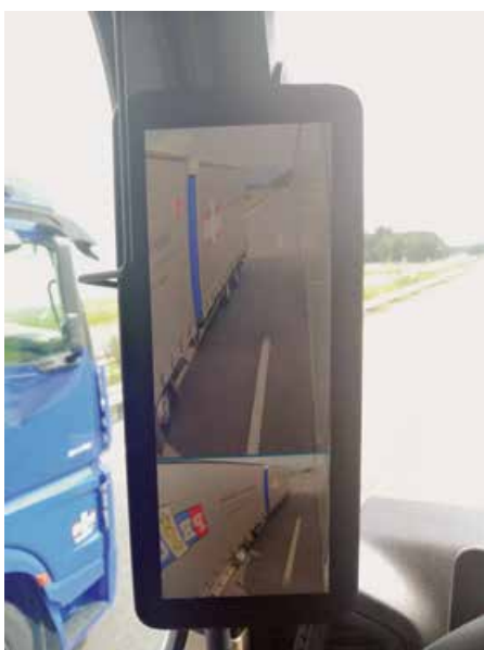
Na stebričku A nameščen ekran, ki zamenjuje vzvratna ogledala.
