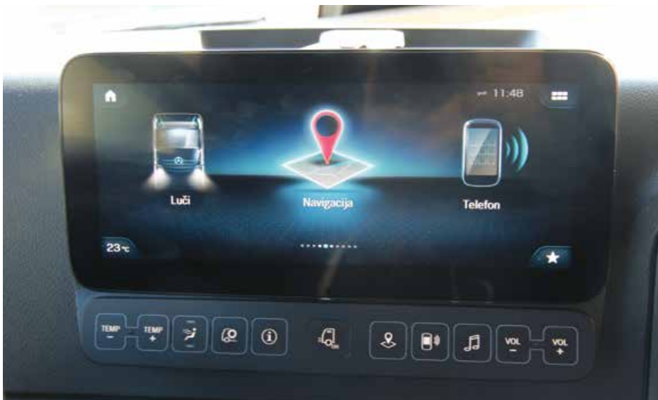
Prek zaslona na sredinski armaturi upravljamo skoraj z vsemi funkcijami, ki so na voljo, za tiste bolj konzervativne pa so na voljo bližnjice v obliki gumbov pod ekranom.
