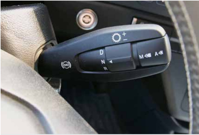
Dve klasični obvolanski ročici. Prek leve krmilimo smernike, brisalce, peremo vetrobransko steklo, spreminjamo snop luči, prek desne pa samodejni menjalnik in retarder.
