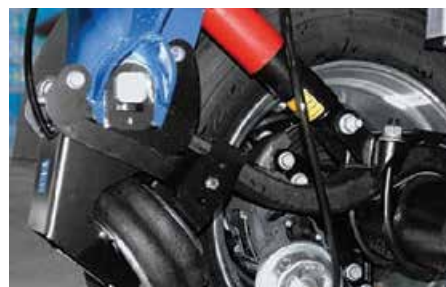
Večina triosnih kontejnerskih polprikolic ima dvizžno prvo os, kar ima lahko dvojni učinek, ko je dvignjena, in sicer se zmanjšuje obraba pnevmatik, kadar je polprikolica prazna ali le delno obremenjena, ob slabšem stiku s podlago v težjih pogojih pa lahko ustvarimo večji pritisk na sedlo in s tem tudi na pogonsko os vlačilca.
