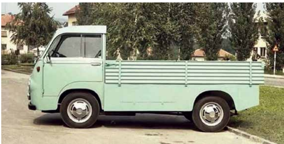
Zaradi sprednjega pogona je bil IMV 1000 odličen za različne prilagoditve tovornega prostora na zadnjem delu. Ena takšnih izvedb je tudi z odprtim koritom in možnostjo pokritosti s cerado.
