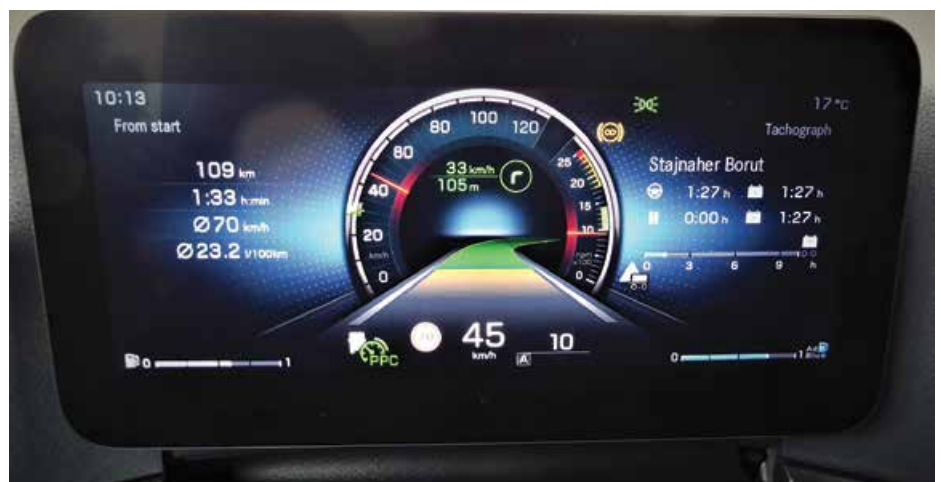
Predvidljivi tempomat je zmeril, da bo čez 105 metrov oster desni zavo, skozi katerega bi bilo najbolj varno peljati s hitrostjo 33 km/h. Sistem bo pred zavojem sam znižal hitrost, po zavoju pa jo ponovno dvignil na prej nastavljeno.
