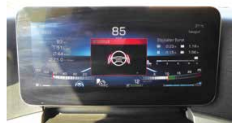
Če spustite volan za več kot 15 sekund, se bo na zaslonu pred vami pojavilo rumeno opozorilo, slišali pa boste tudi opozorilni ton. Po 30 sekundah se bo opozorilo obarvalo rdeče, piski pa bodo kontinuirani. Po eni minuti, če ne boste prijeli za volan, se bo Active Drive Assist izklopil.
