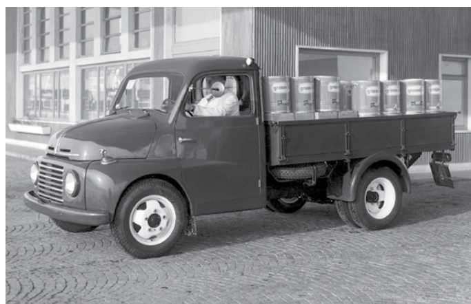
V začetku 50-tih let so nastali prvi modeli tovornjakov, med katerimi je bil tudi Fiat 615, po njegovi licenci pa je od leta 1955 v Kragujevcu nastajala Zastava 615. Na začetku je vse tri Zastavine modele poganjal enak 1385-kubični bencinski motor, kmalu pa so mu dodali tudi večjega 1,9-litrskega.
