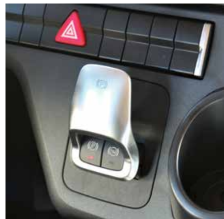
Ročica električne parkirne zavore ima sedaj več funkcij prek dodatnih stikal na njej. Levo stikalo je Hill Holder, ki drži vozilo zavrto v klanecu brez časovne omejitve, desno stikalo pa je namenjeno samostojnemu zaviranju polprikolice.
