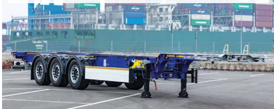
Schmitzova S.CF Goosnesck 45 Euro Light je olajšana izvedba kontejnerske polprikolice, z lastno maso vsega 4250 kilogramov, namenjena prevozu 40- in 45-ft kontejnerjev.
