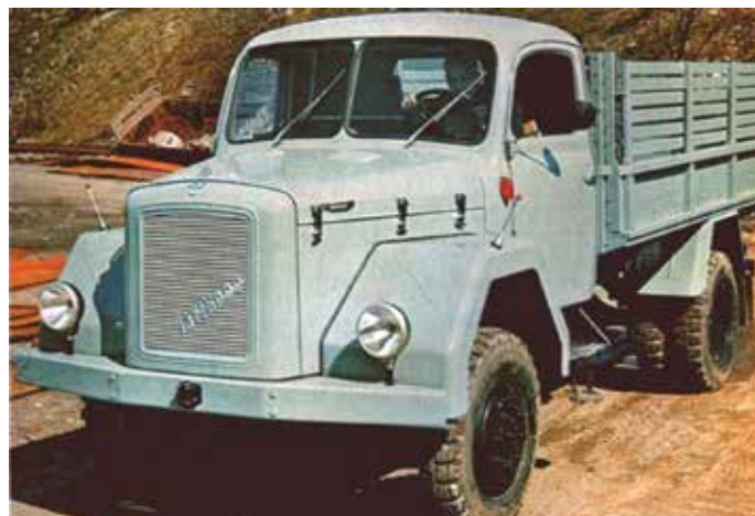
TAM 5000 D – od leta 1960 je bil v ponudbi model z nosilnostjo 5 ton, oznaka D pa je nakazovala na vsekolesni pogon 4x4, ki je bil na voljo tudi pri osnovnem modelu 4500, kakor tudi prekučna nadgradnja.
