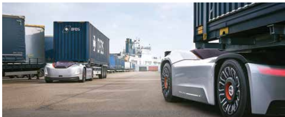
Vera je novodobno električno, povezano in avtonomno vozilo. Pri Volvu verjamejo, da bodo v bližnji prihodnosti večino tovornjakov še vedno upravljali ljudje.
