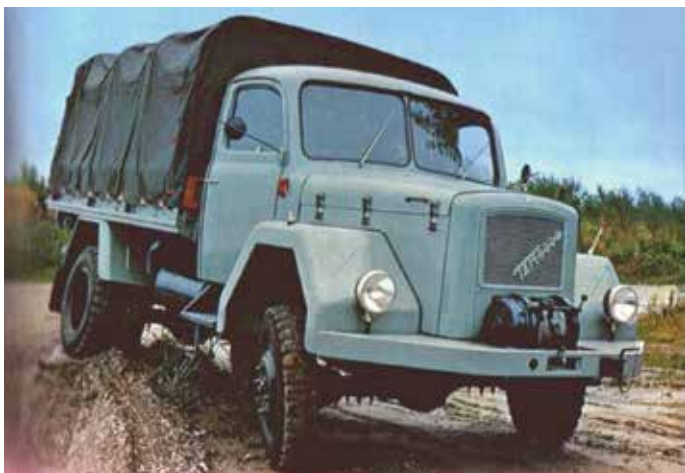
TAM 5000 DV – dodatna oznaka V označuje vitel. TAM je s tem modelom močno prekosil FAP v deležu vozil voznega parka JLA.
