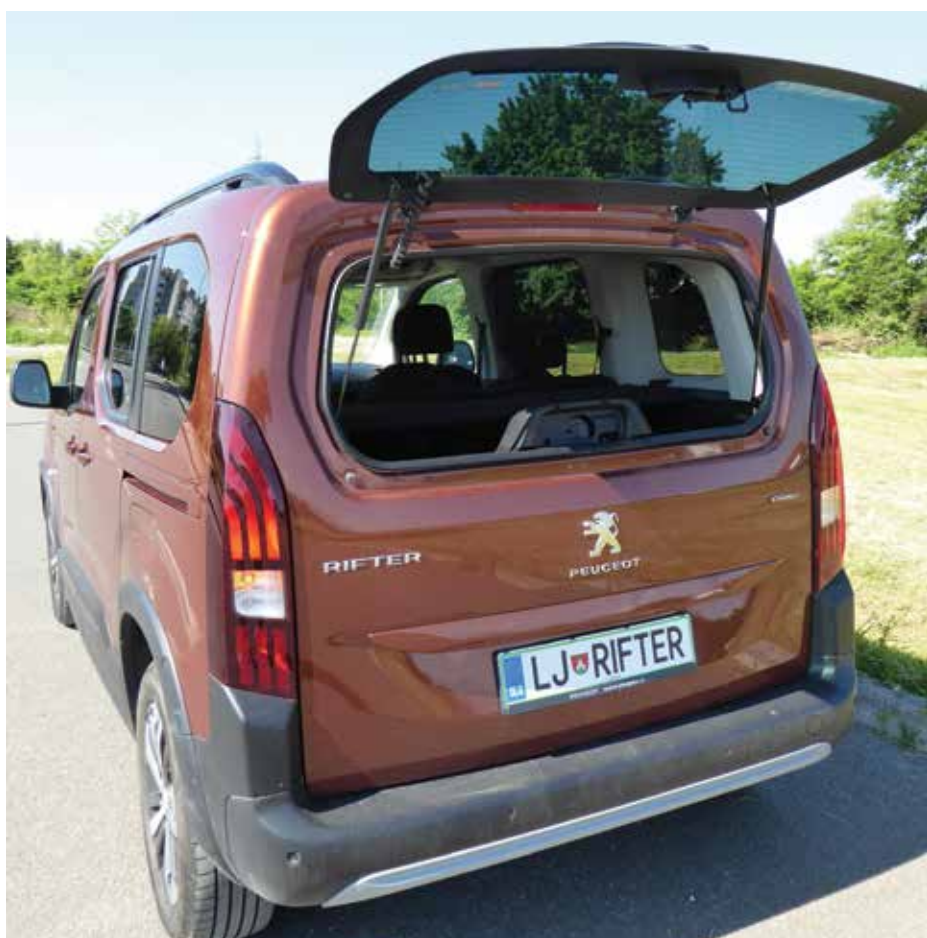
Dobrodošla malenkost, ki omogoča odpiranje le stekla na prtljažnih vratih.
