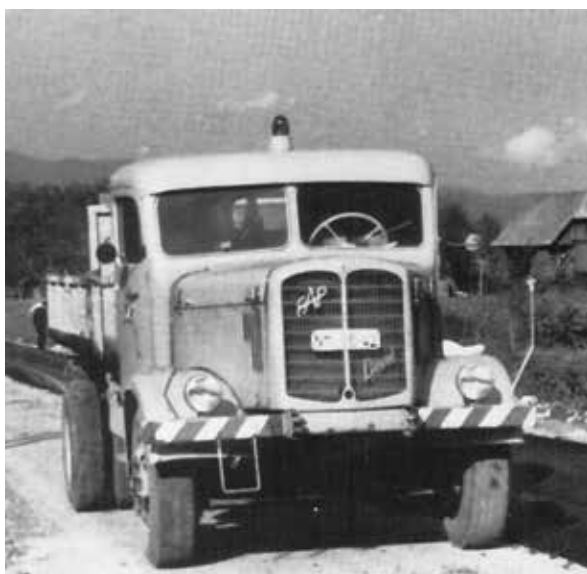
FAP 6G je bil z nosilnostjo 6 ton ter 6-valjnim dizelskim motorjem s prostornino 7982 ccm in močjo 130 KM brez prave konkurence na jugoslovanskem trgu.
