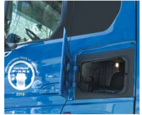
Pod posteljo sta še dva velika predala za orodje in opremo, ki pa sta dostopna z zunanje strani.
