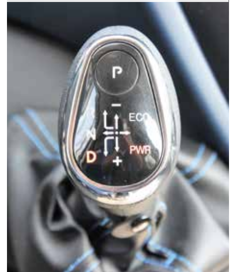
Ročica služi za vzpostavitev prenosa naprej ali nazaj prek moto-generatorja. P stikalo služi vklopu in izklopu akustičnega signala.
