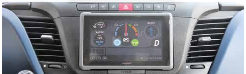
Na sredini armature je poseben zaslon, ki daje vozniku vse potrebne informacije, o stanju baterije, kondenzatorja, napetosti, dosega ...
