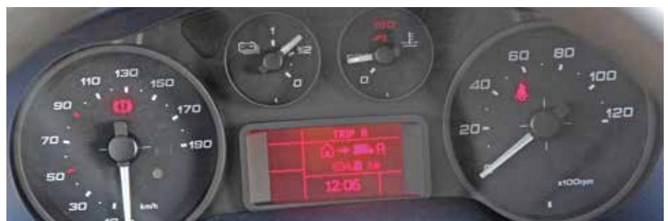
Merilniki merijo hitrost in število vrtljajev, pa tudi napetost baterije in njeno temperaturo.
