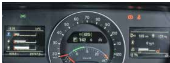
Na plošči z merilniki je med podatki dodana vrstica, ki ob količini dizla in AdBlueja kaže še količino plina.
