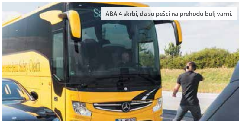
Sistem Sideguard Assist ima za sprednjim blatnikom vgrajen senzorski sistem, ki nadzira 3,75 metra širok prostor ob boku vozila in opazi pešce, kolesarje ali stacionarne objekte.
