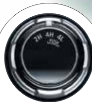
Super Select stikalo omogoča preklap med dvo- in štirikolesnim pogonom ter vklop blokade diferenciala.
