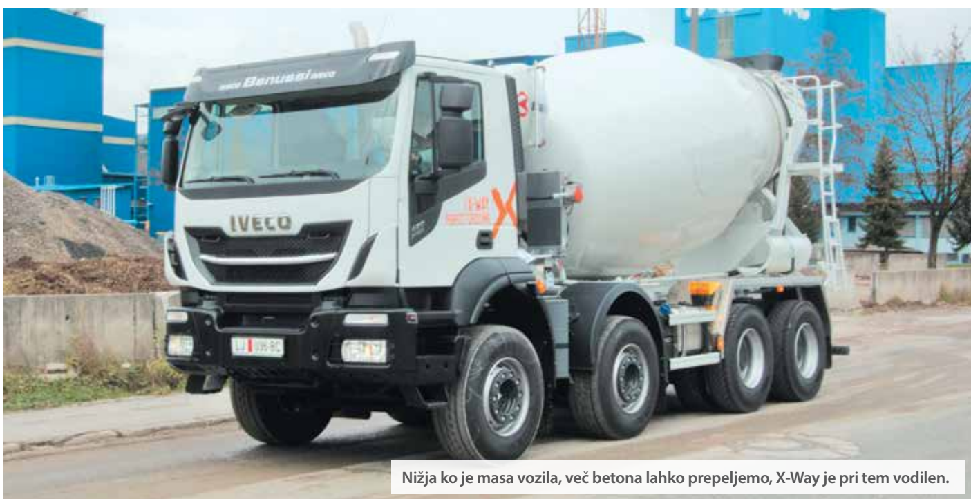
Stralis X-Way je eno tistih vozil, ki s svojo modularnostjo in lahkotno, a čvrsto zgradbo izredno pogodujejo nadgradnji betonskih mešalnikov.
