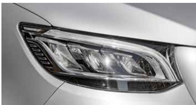
LED luči so dražje od klasičnih H7 žarnic, a je njihova življenjska doba vsaj 10-krat daljša od klasične žarnice, porabijo veliko manj energije, ponujajo boljše vidljivost in na koncu lepše izgledajo.
