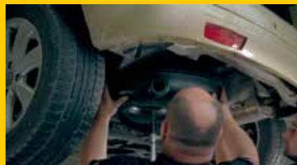
Posoda za plin se namesti v prostor za rezervno kolo, zelo redko pa lahko tudi v prtljažnik.
