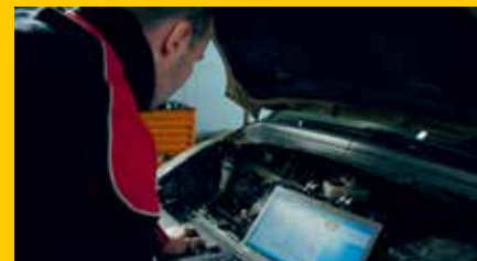
Pred koncem vgradnje je treba računalniško nastaviti delovanje motorja s pogonom na plin.
