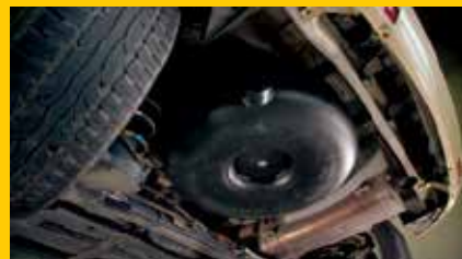
Posoda za plin je izdelana iz čvrstega jekla in odporna na udarce, zato prenese velike sile tudi ob morebitnem trku vozila.
