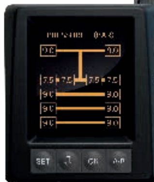
Senzor v pnevmatiki (1) oddaja signal v centralno kontrolno enoto (2), ta pa prikaže stanje na zaslonu v kabini (3).
